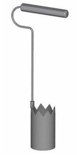
Obr. 3 Naběračka s výřezy pro odběr kapalin
