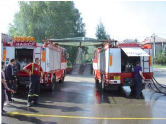
Obr. 71, 72 Krok 3 vytváření provizorního dekontaminačního stanoviště s využitím cisternových automobilových stříkaček a nastavovacích žebříků
