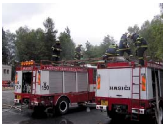
Obr. 67, 68 Krok 1 vytváření provizorního dekontaminačního stanoviště s využitím cisternových automobilových stříkaček a nastavovacích žebříků
