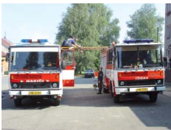
Obr. 69, 70 Krok 2 vytváření provizorního dekontaminačního stanoviště s využitím cisternových automobilových stříkaček a nastavovacích žebříků
