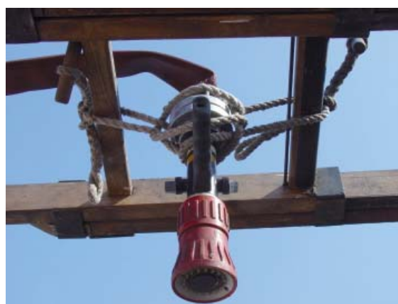
Obr. 69, 70 Krok 2 vytváření provizorního dekontaminačního stanoviště s využitím cisternových automobilových stříkaček a nastavovacích žebříků
