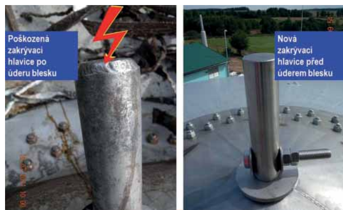
Obr. 4 Porovnání horních dílů fermentoru po úderu a před úderem blesku
