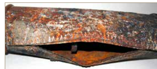
Obr. č. 4: Pohled na roztržený tlumič výfuku - roztržení bylo způsobeno explozivním hořením/výbuchem směsi paliva ve výfuku.
