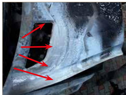
Obr. č. 2: Pohled na ohniskové markanty znatelné na karoserii vozidla s vyznačením směru šíření tepelné energie.
