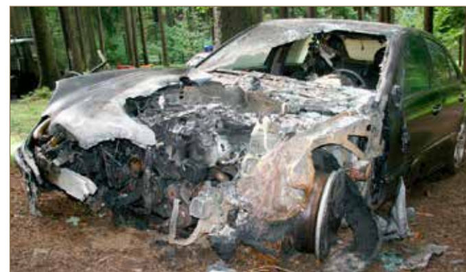
Obr. č. 2: čelní pohled na poškozené vozidlo s detailem zaměřeným na lokalizované kriminalistické ohnisko.
