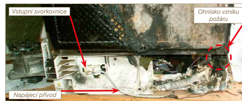
Obr. č. 3: Napájecí přívod s a jeho ukončení vzhledem k pozici ohniska.
