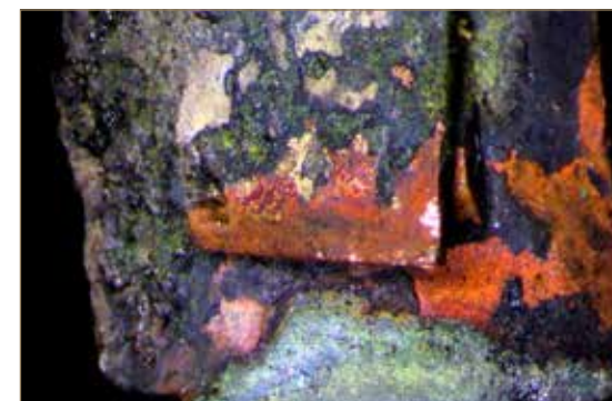
Obr. č. 7: Mikroskopický detail předmětného kontaktu, jehož styčné plochy jsou vlivem elektrického oblouku zataveny.
