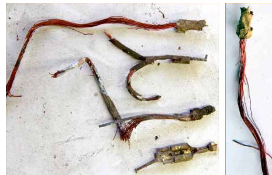
Obr. č. 4 a 5: Lokalizované tepelné poškození mosazných svorek.
