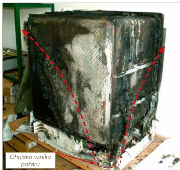
Obr. č. 1: Ohniskový kužel vyznačený na zadní a levé boční stěně myčky BOSCH.
