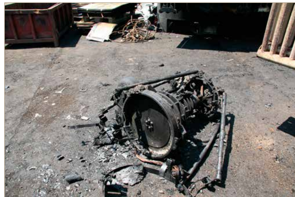
Obr. č. 3: Část přepínače se silovými kontakty.
