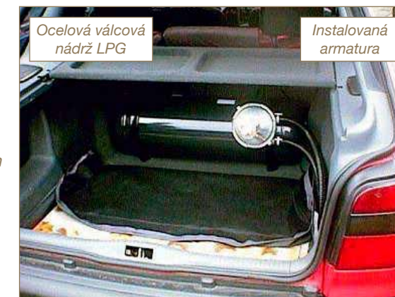
Obr. č. 6: Pohled do zavazadlového prostoru vozidla Škoda Felicia combi s instalovanou ocelovou nádrží - totožná instalace jako u poškozeného vozidla.
