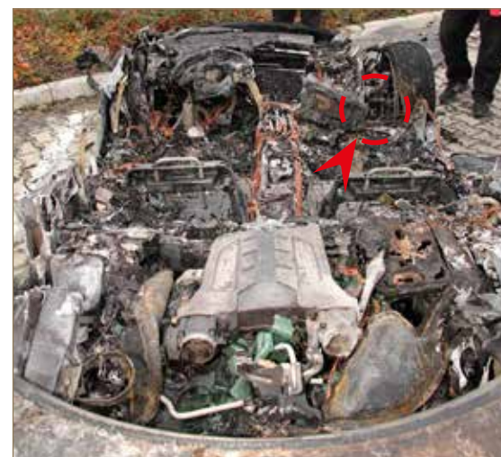
Obr. č. 3: Pohled do interiéru torza Audi R8 s vyznačeným ohniskem, kde došlo k poškození izolace silového kabelu od + pólu AKU k rozvodné liště.
