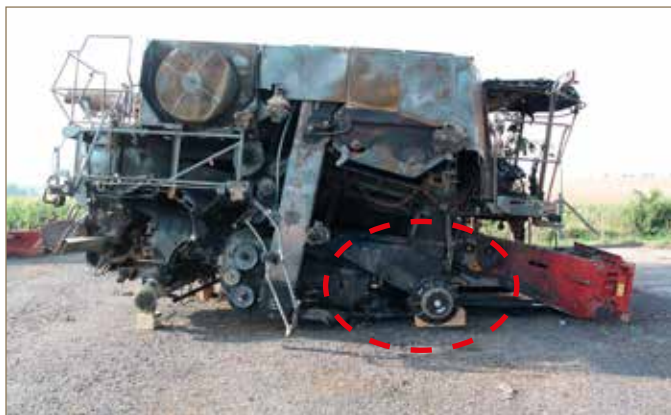
Obr. č. 1: Předmětný kombajn CASE 9230 poškozený požárem s vyznačeným kriminalistickým ohniskem.
