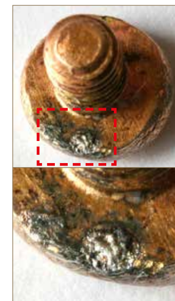
Obr. č. 5 a 6: Tepelné poškození hlavy šroubu z vrchního kontaktu ochranného kolíku s detailem.
