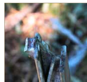
Obr. č. 9: Plastový držák na elektrický ohradník poškozený účinkem blesku (patrné natavení plastu).
