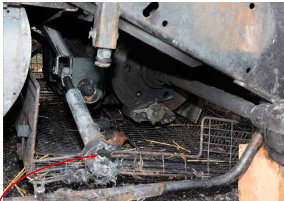
Obr. č. 3 a 4: Detailní pohled na elektromechanický systém vyvážení síťové skříně, který způsobil vznik požáru. Pro porovnání je na obr. č. 4 záběr na nepoškozený stroj.
