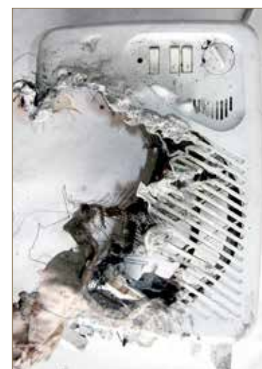
Obr. č. 6: Pohled na čelní stěnu požárem poškozeného tepelného ventilátoru.
