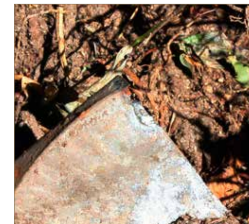
Obr. č. 8: Nátav vzniklý účinkem blesku na plech zakopaný v půdě (obnažení plechu).
