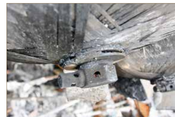
Obr. č. 4: Detailní pohled na ventil tlakové lahve po požáru (aktivace tepelné pojistky proběhla bez závad).
