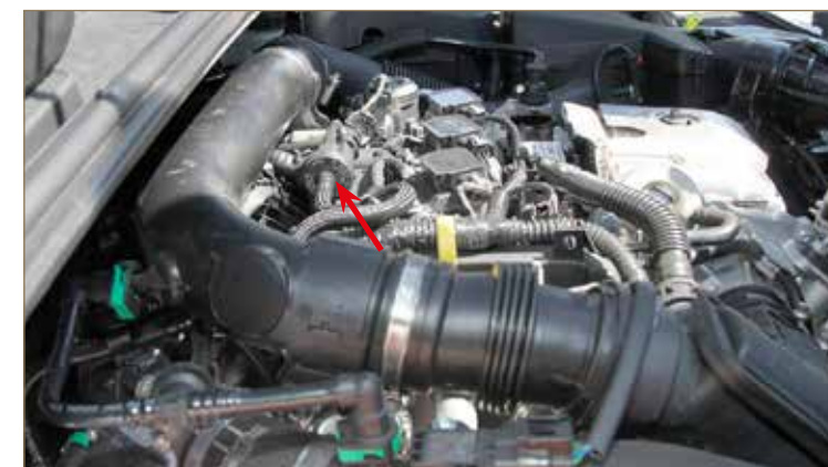
Obr. č. 6: Vyznačení pozice předmětného palivového ventilu a závadného spojení s palivovou trubicí u nepoškozeného vozidla.
