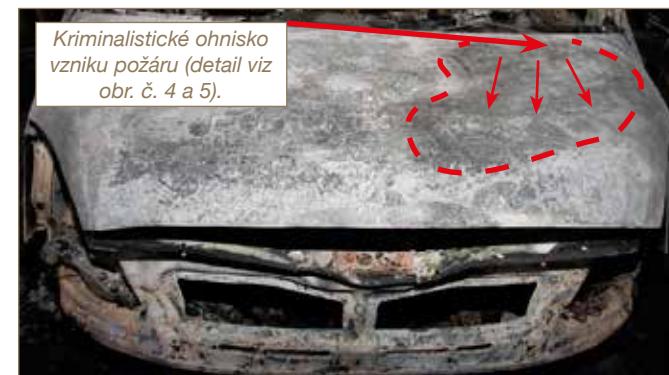
Obr. č. 2: Pohled na ohniskové markanty zřetelné na přední kapotě vozidla.
