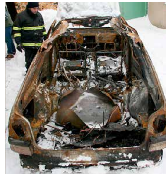
Obr. č. 1: Pohled na poškozené vozidlo skrz páté dveře - ztelné explozivní příznaky.
