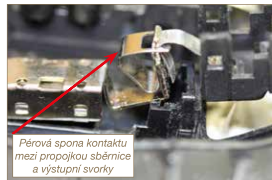
Obr. č. 6: Detail kontaktu a pérové trojúhelníkové spony, jejíž absence způsobila požár.
