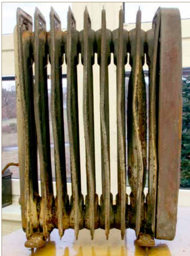
Obr. č. 1: Boční pohled na olejový radiátor s vyznačeným vydutím od vnitřního přetlaku při neregulované funkci topného tělesa.
