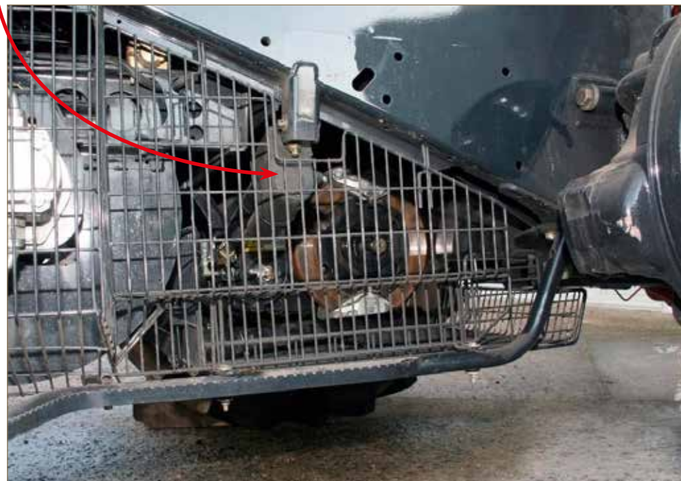
Obr. č. 3 a 4: Detailní pohled na elektromechanický systém vyvážení síťové skříně, který způsobil vznik požáru. Pro porovnání je na obr. č. 4 záběr na nepoškozený stroj.
