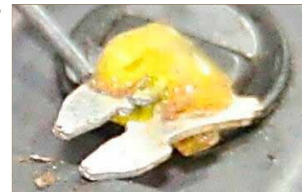
Obr. č. 5: Pohled na roztavenou nožovou tavnou pojistku.
