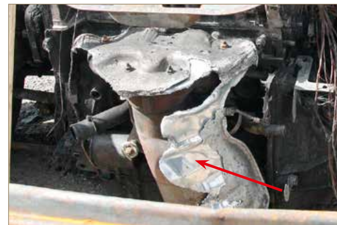
Obr. č. 2: Pohled na tepelnou destrukci krytu filtru pevných částic – v jeho horní části je porušen vnější plášť.
