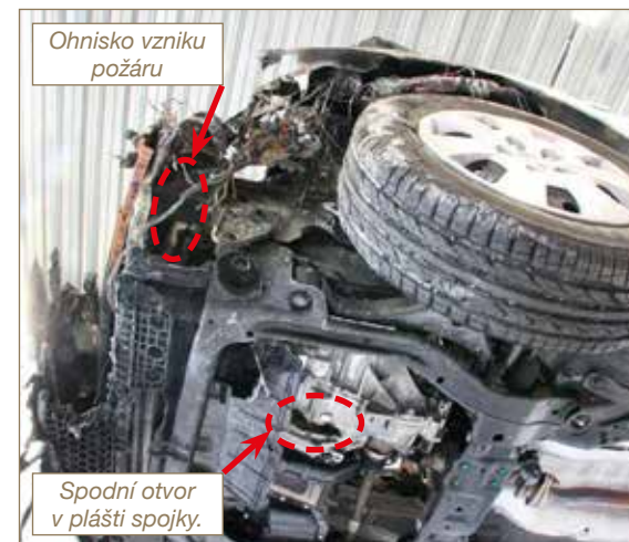
Obr. č. 2: Pohled na ohnisko a jeden z otvorů ve spojce.
