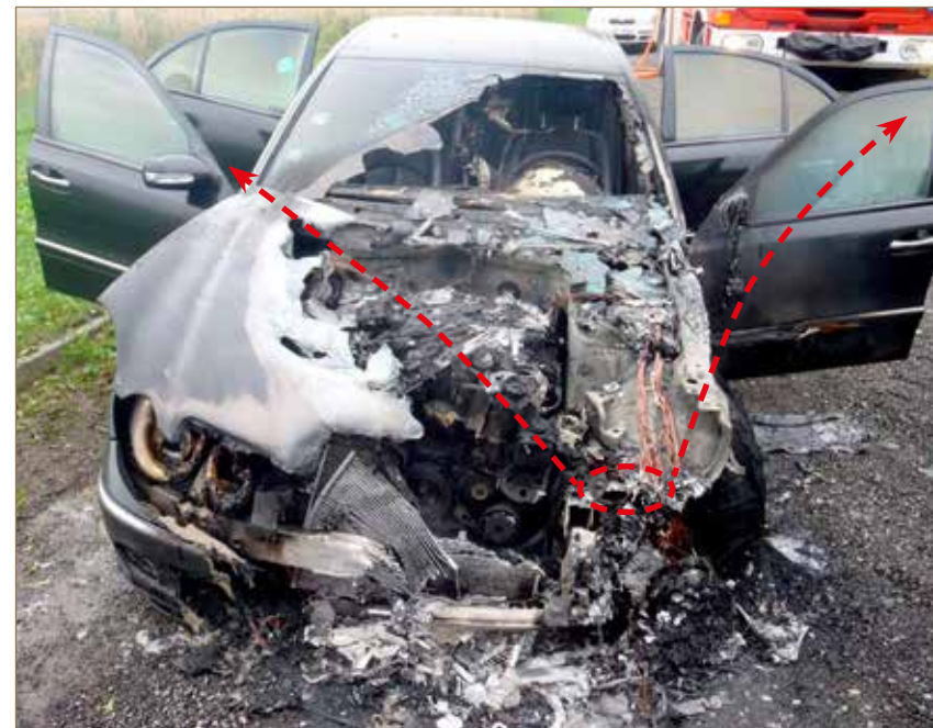
Obr. č. 2: čelní pohled na poškozené vozidlo s detailem zaměřeným na lokalizované kriminalistické ohnisko.
