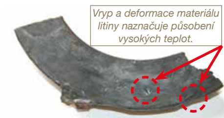
Obr. č. 5: Část přítlačného litinového kotouče spojky se stopami po působení vysokých teplot.
