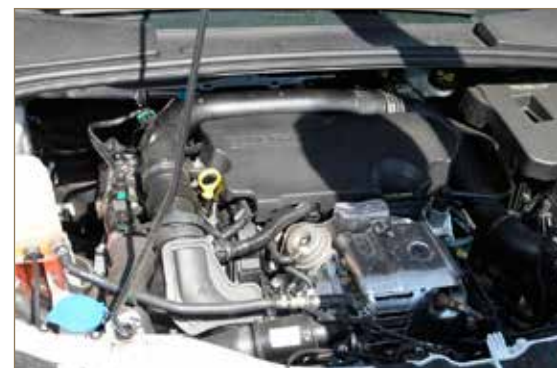
Obr. č. 4: Nepoškozený motorový prostor vozidla se shodným agregátem pro porovnání stavu před požárem.
