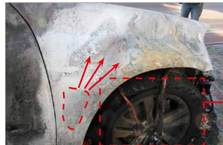
Obr. č. 3: Pohled na ohniskové markanty znatelné na blatníku vozidla.
