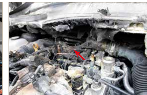
Obr. č. 5: Vyznačení pozice předmětného palivového ventilu v ohnisku.
