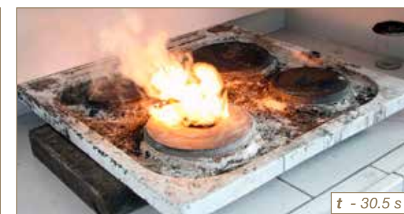
Obr. č. 6: Vznícení vzorku tepelné izolace v čase t .
