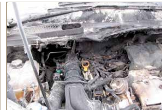
Obr. č. 3: Ohniskové markanty na fragmentech motorového prostoru.
