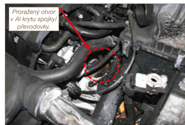
Obr. č. 6: Pohled do motorového prostoru vozidla shora, s detailem na proražený otvor v Al krytu spojky/převodovky.
