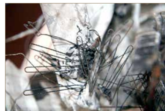
Obr. č. 3: Žhavicí odporová spirála topného tělesa zatavená do plastového krytu ventilátoru.
