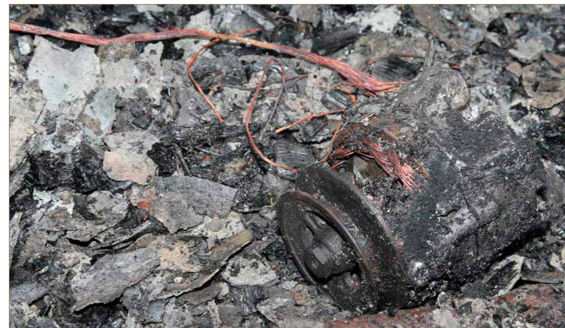
Obr. č. 3: Pohled na alternátor uvolněný z jeho původního uchycení.
