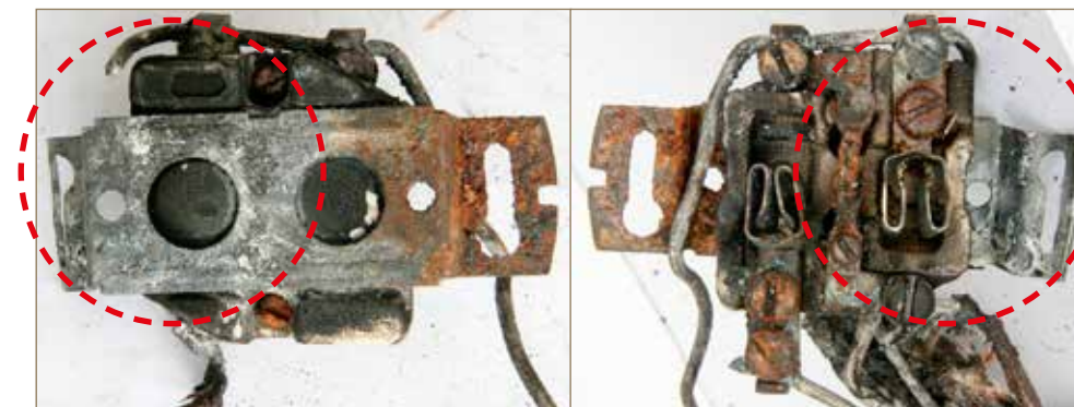
Obr. č. 2 a 3: Vyžhání přední a zadní strany zásuvky.
