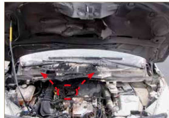
Obr. č. 2: Kriminalistické ohnisko požáru (oblast vymezená červeným kruhem) s vyznačeným ohniskovým kuželem.
