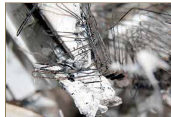
Obr. č. 2: Žhavicí odporová spirála topného tělesa zatavená do plastového krytu ventilátoru.
