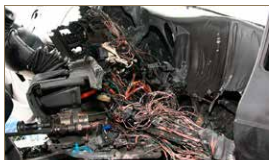
Obr. č. 4: Odkrytovaný prostor kriminalistického ohniska – automobilových zásuvek.
