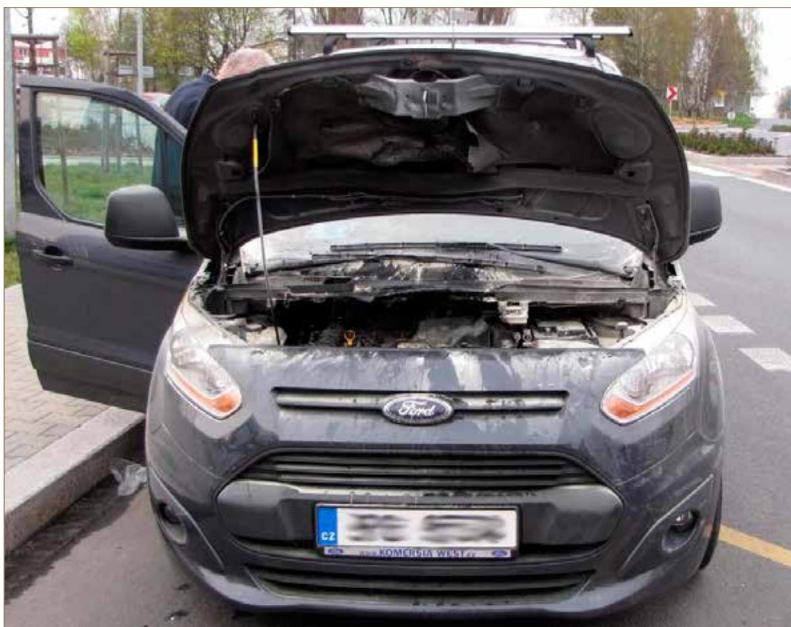
Obr. č. 1: Motorový prostor vozidla Ford Transit Connect bezprostředně po požáru.
