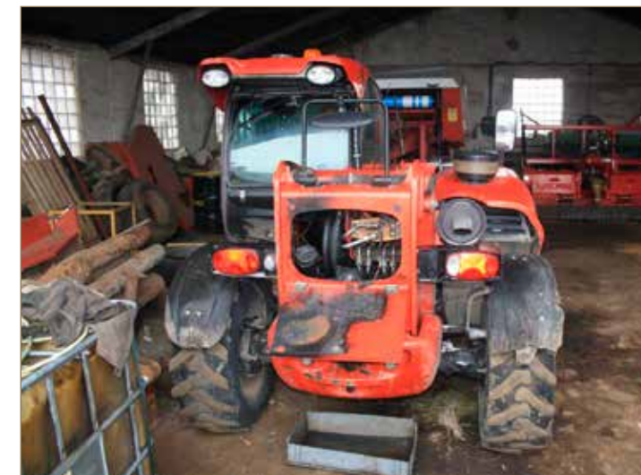
Obr. č. 3: Pohled za zadní část manipulátoru, kde došlo ke vzniku požáru.
