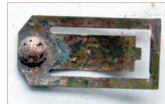
Obr. č. 3: Spínací kontakt termostatu s poškozením od elektrického oblouku.
