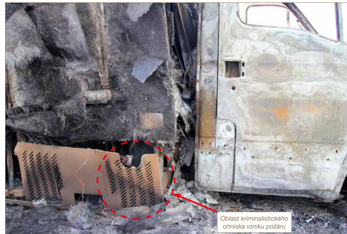
Obr. č. 2: Pohled na umístění rozvaděče a elektroinstalace napájení kompresoru.
