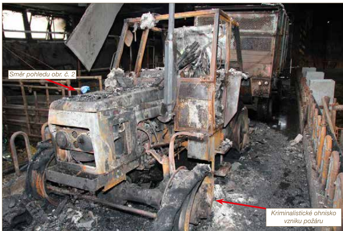
Obr. č. 1: Pohled na požárem zasažený traktor.
