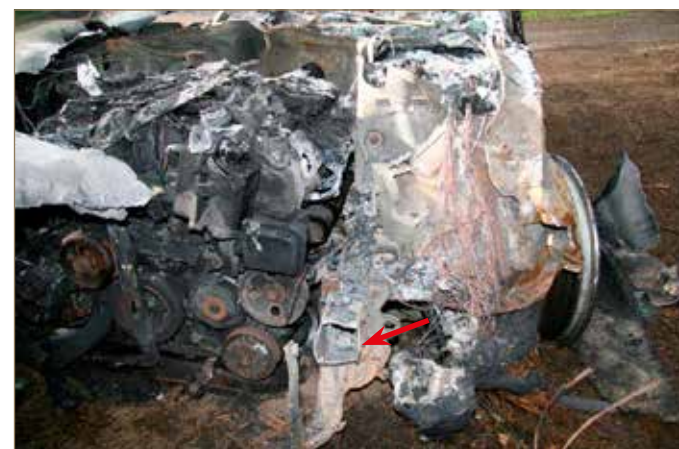
Obr. č. 3: pohled na roztavené/shořelé Al nosníky vozidla.
