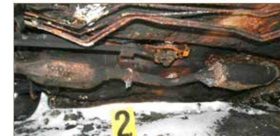
Obr. č. 2: Pohled na podvozek vozidla s výfukovým potrubím a kloubem řadicí páky.
