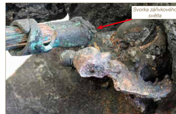
Obr. č. 3: Pohled na markanty znatelné na svorce odpojovače akumulátoru.
