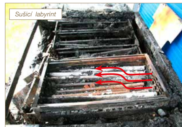
Obr. č. 3: Vyznačení proudění vyhříváného vzduchu od topných spirál.
