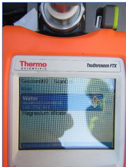
Mobilní infračervený spektrometr FTIR pořízený z projektu Technika, technologie a prostředky Hasičského záchranného sboru Zlínského kraje pro efektivní zásah – detail měření při nasazení u mimořádné události
