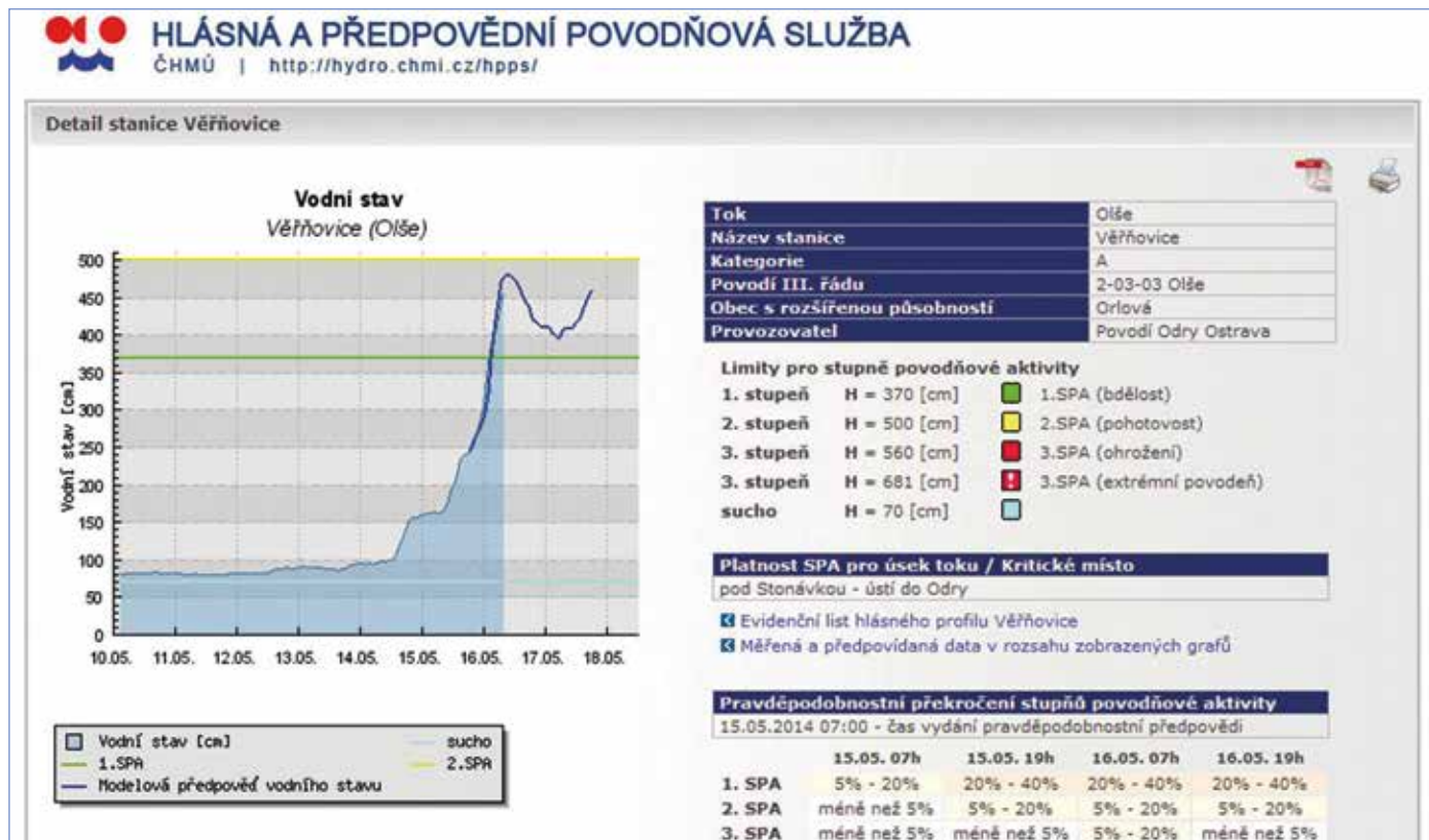
Obr. 2 Ukázka prezentace pozorovaných dat a předpovědi pro vodoměrnou stanici Věřňovice na Olši v Moravskoslezském kraji ( http://hydro.chmi.cz/hpps/ ). V pravém dolním rohu je vyhodnocení výsledků pravděpodobnostní předpovědi, které udává pravděpodobnost překročení jednotlivých úrovní SPA v průběhu 12hodinových intervalů předstihu předpovědi.
