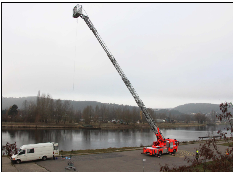
Obrázek č. 3: Zátěžová zkouška AZ 30
