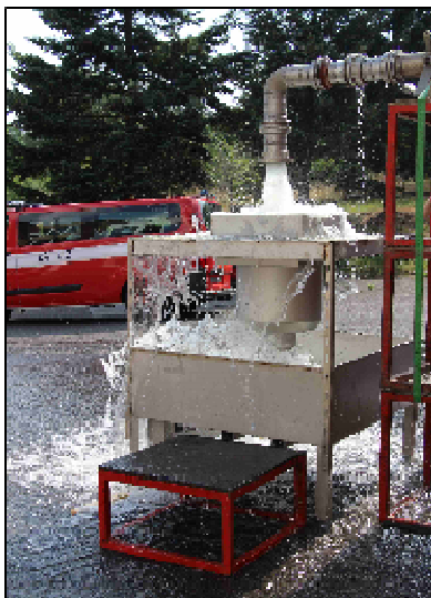
Obrázek č. 1: Zkoušky kanálové výpusti
