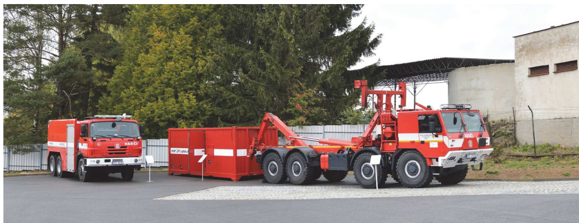
Obrázek 1 Mobilní úpravna vody v kontejnerovém provedení, cisterna na pitnou vodu (foto – zdroj: webové stránky Ministerstva pro místní rozvoj České republiky)
