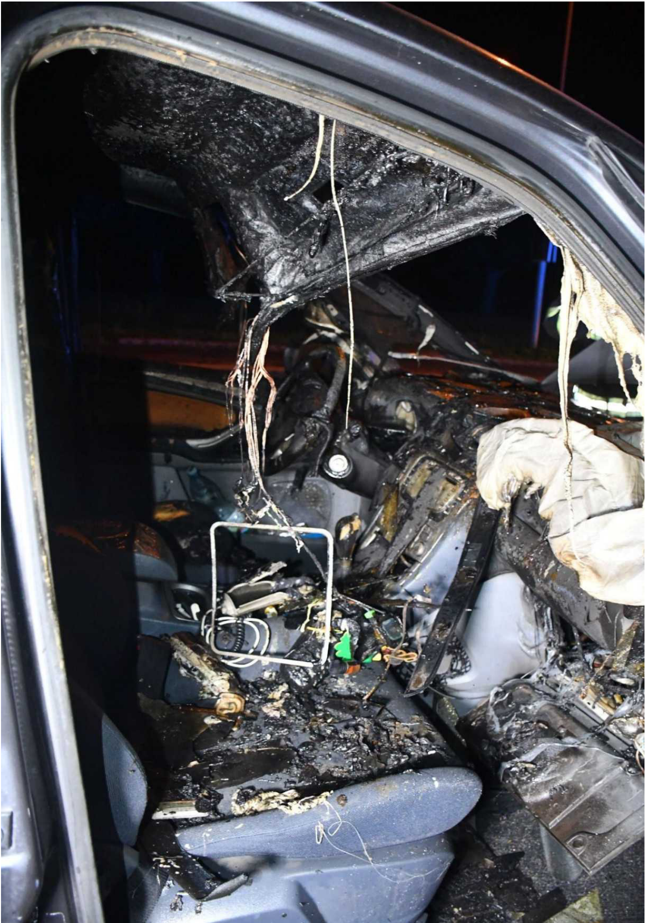
Fotografie č. 5 pohled do přední vnitřní části vozu poškozené požárem. Při požáru došlo k poškození předního okna a požár se mohl dále šířit do vnitřního prostoru vozu.
