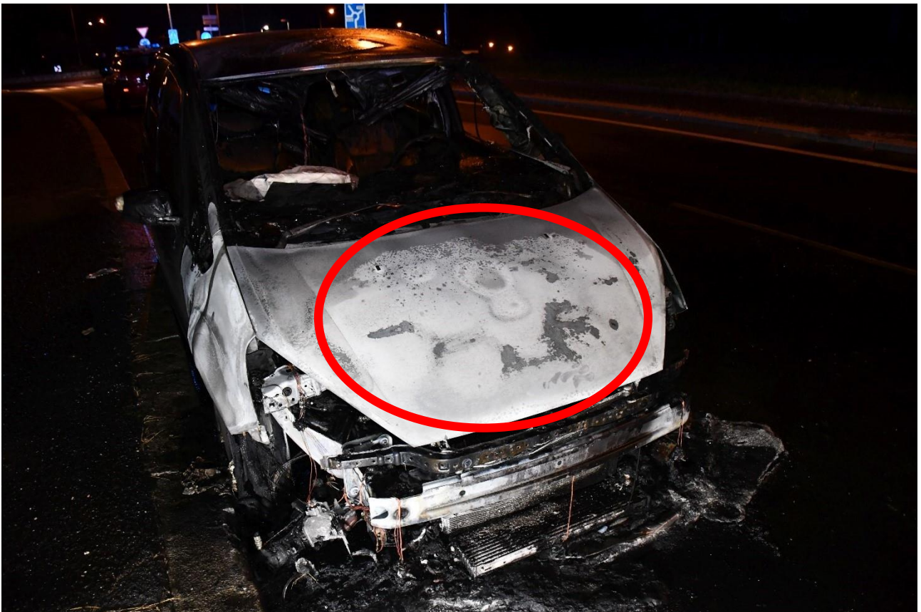
Fotografie č. 2 celkový pohled na přední kapotu osobního vozu s vyznačeným vypáleným lakem pozíčně nad místem ohniska požáru.
