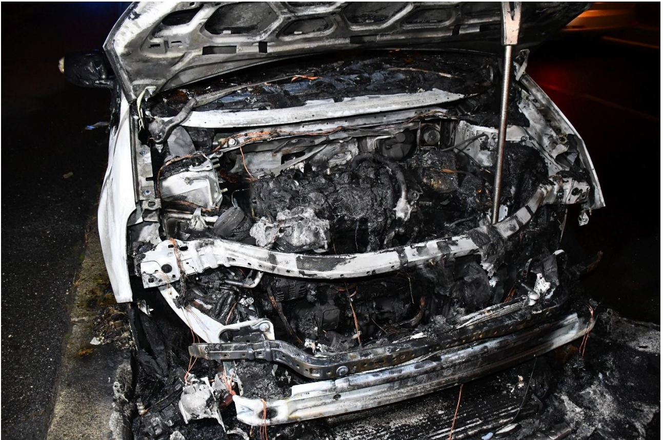
Fotografie č. 3 celkový pohled na kriminalistické ohnisko požáru ve střední části motorového prostoru. Situačně v místě napojení přívodu paliva (nafta) do motoru (stříčky, přívodní hadička).
