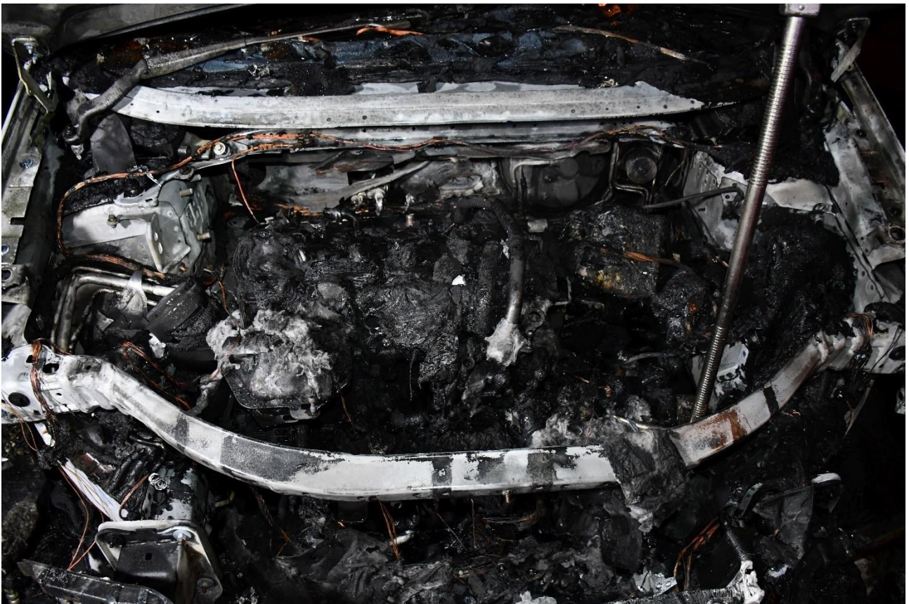
Fotografie č. 4 detailní pohled na kriminalistické ohnisko místa vzniku požáru uprostřed motorového prostoru.
