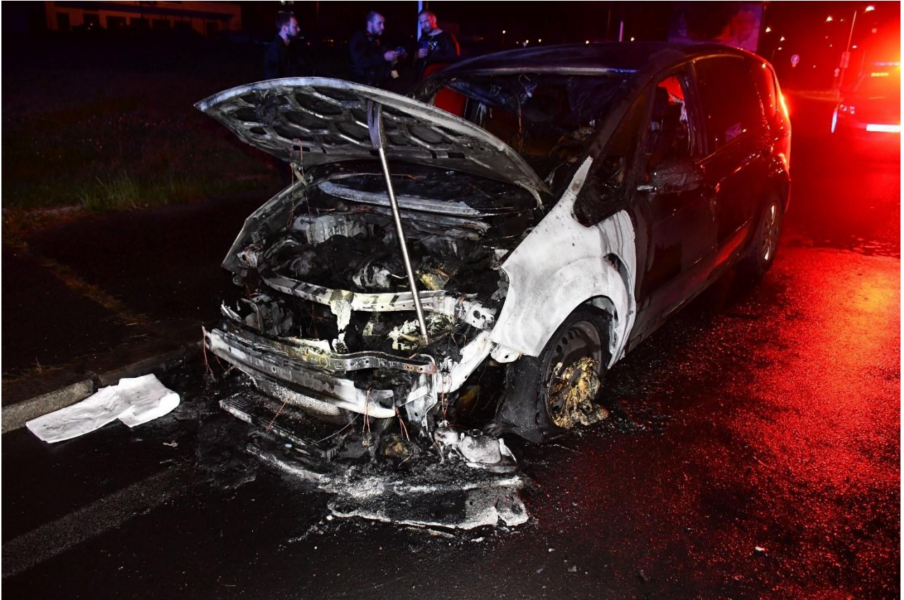
Fotografie č. 1 celkový pohled na požárem zasažené osobní vozidlo FORD S MAX, Požárem je zasažena přední motorová část vozu a vnitřní prostor.
