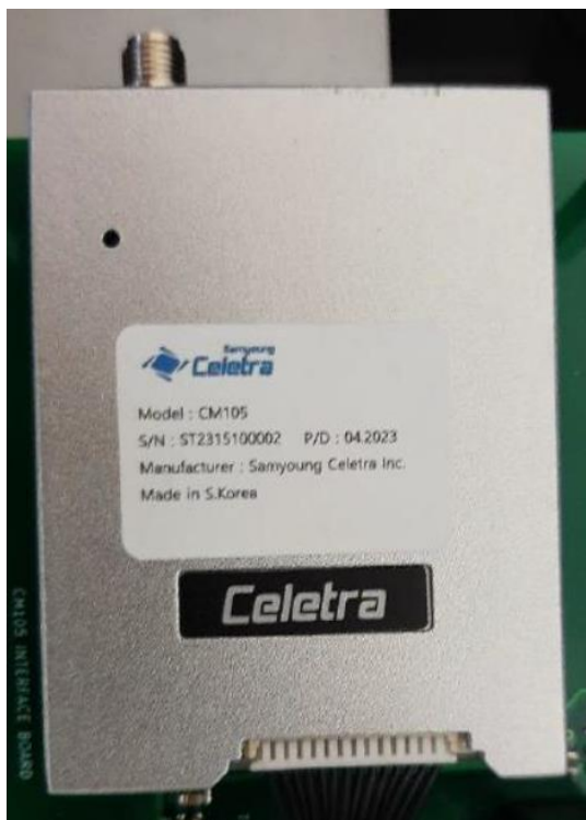
KPPS 2. vrstvy JSVV – radiostanice DMR
