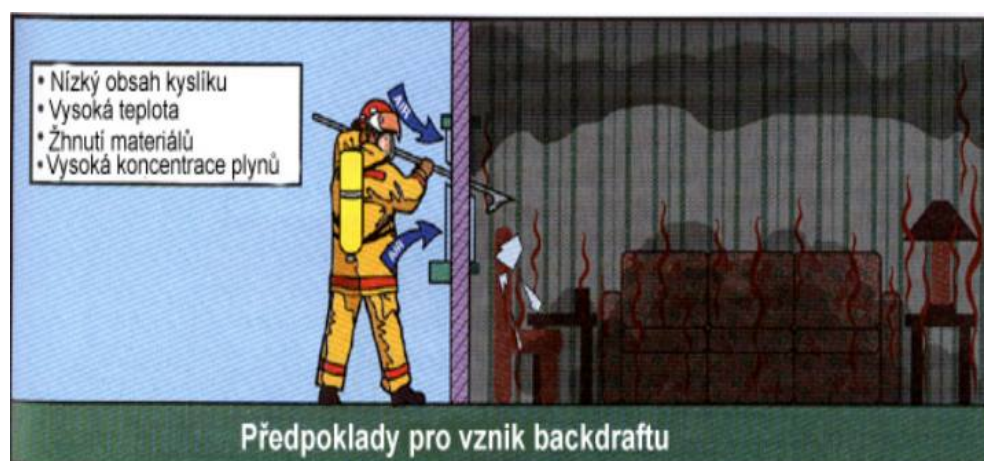
Obrázek č. 5 Porušení těsnosti místnosti.
