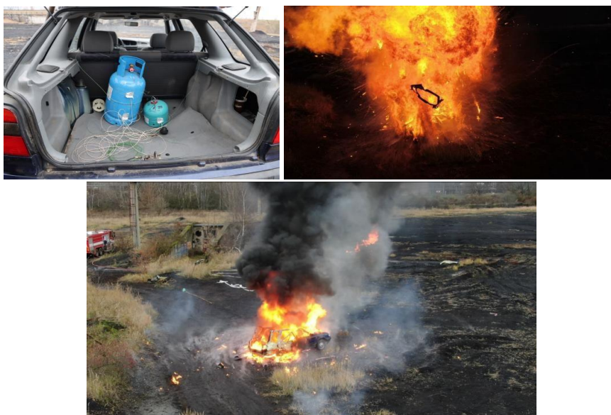
Obr. 3 Osobní vozidlo s tlakovou lahví před zkouškou a po zkoušce
