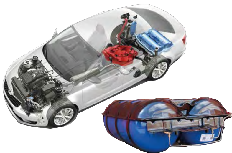
(a) Umístění nádrží ve vozidle (převzato z [6]) a detail nádrží v držáku.
