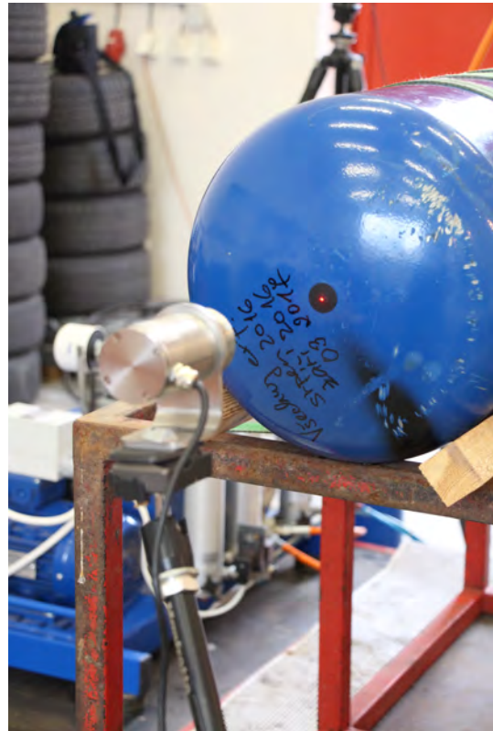
(c) Měření teploty povrchu IČ teploměrem
