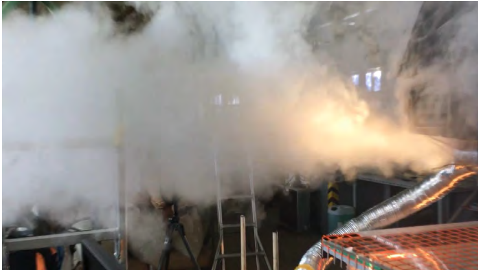
Obr. 13: Kouřová vizualizace proudění – výtrysk za zasním pravým kolem vozidla
