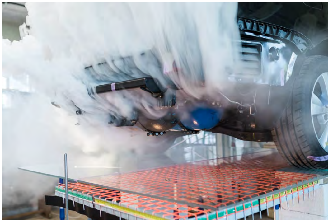
Obr. 9: Kouřová vizualizace proudění – přisávání vzduchu v zadní části vozu
