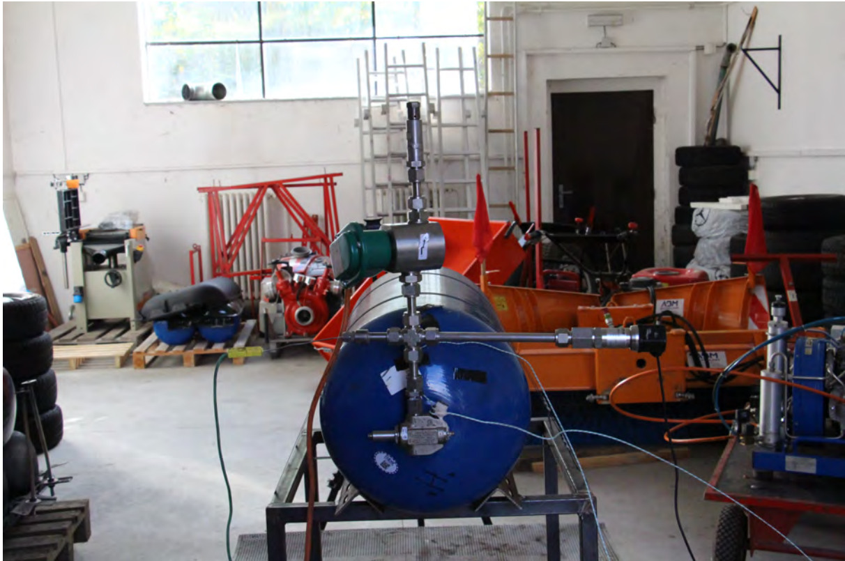
Obrázek 2.9: Nástavec pro měření se vzdáleným otvíráním výtokové cesty plynu.
