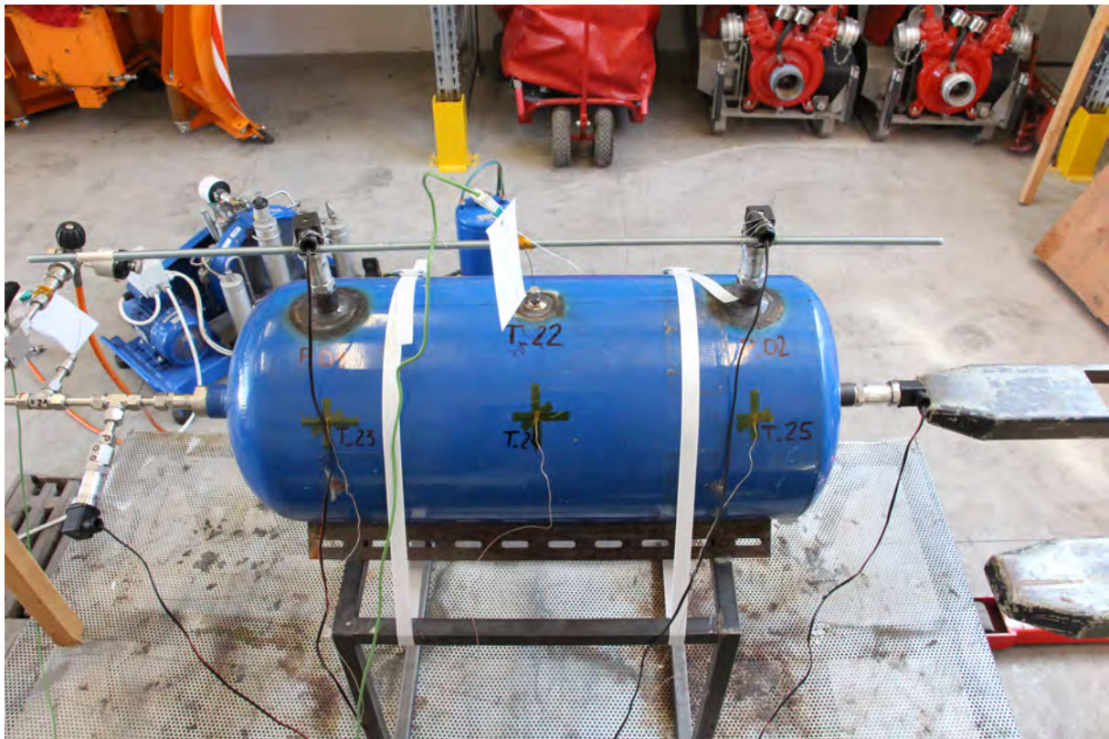
Obrázek 2.5: Experimentální aparatura pro měření dynamiky výtoku vzduchu z upravené tlakové nádoby.
