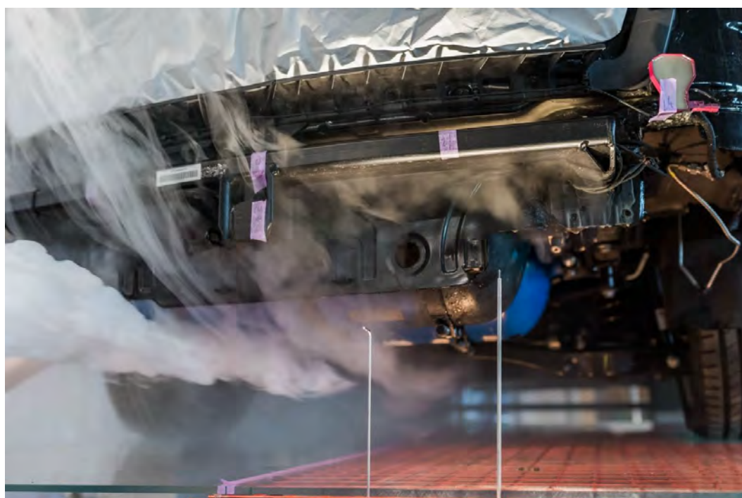
Obr. 12: Kouřová vizualizace proudění – zadní část vozu, umístění dvou tlakových sond
