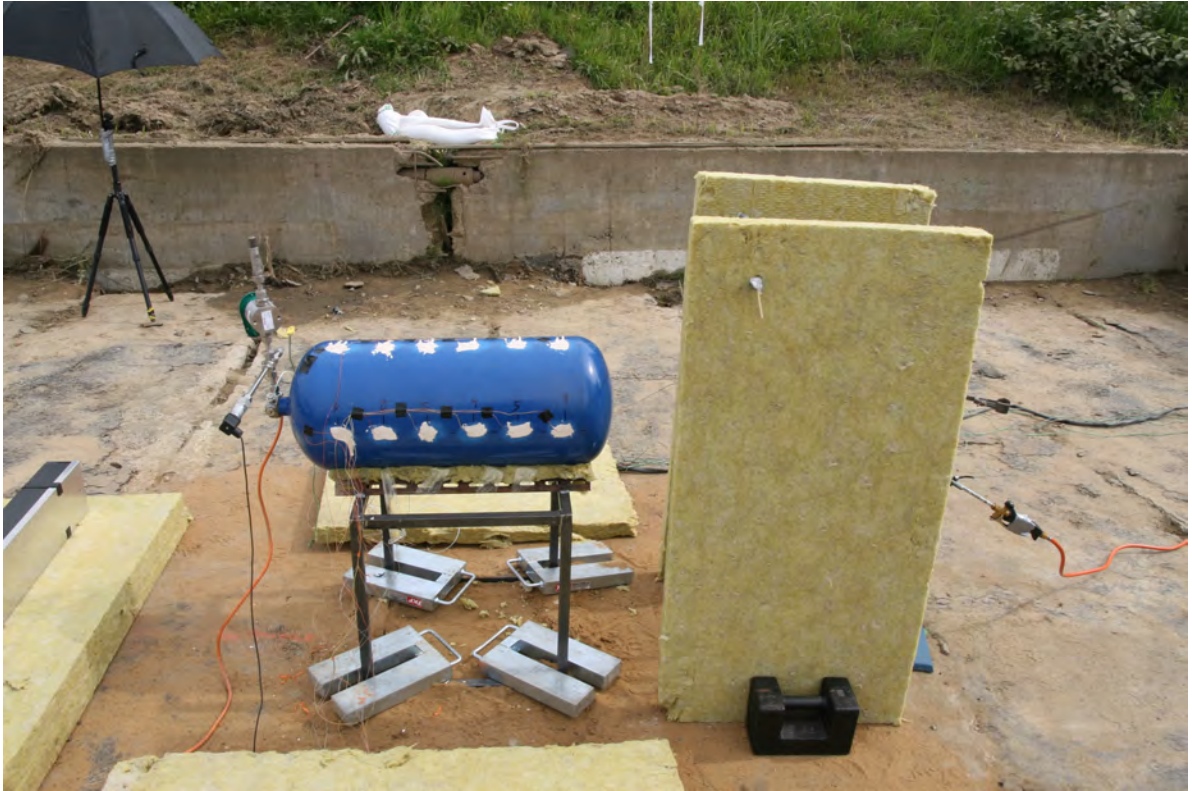
(a) Láhev na stojanu s nalepenými termočlánky.
