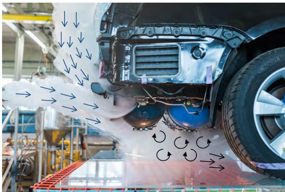
Obrázek 2.29: Kouřová vizualizace proudění za autem a kolem tlakových nádrží.
