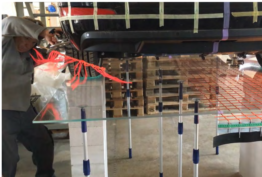
Obr. 8: bavlnkový test - změna proudění
