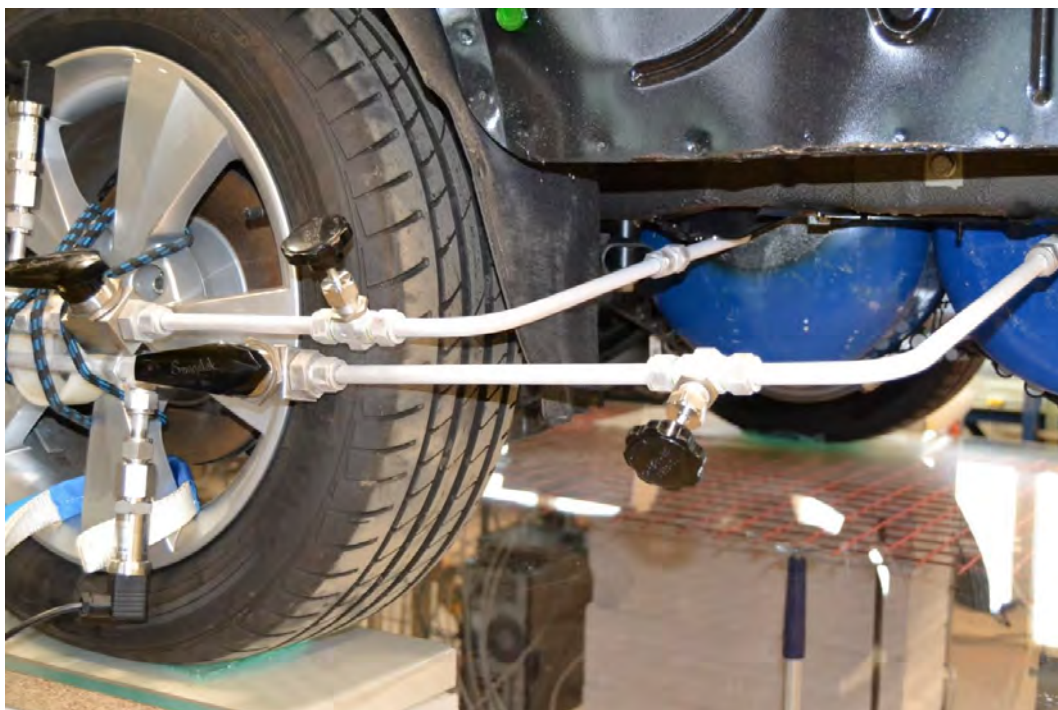
Obr. 5: tvorba jinovatky na přívodním potrubí k ventilům
