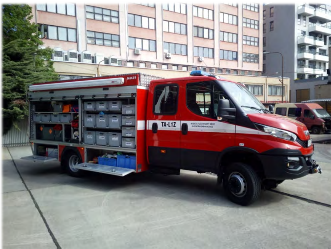
Obrázek 36 - Vozidlo střelmistra, výbava.
