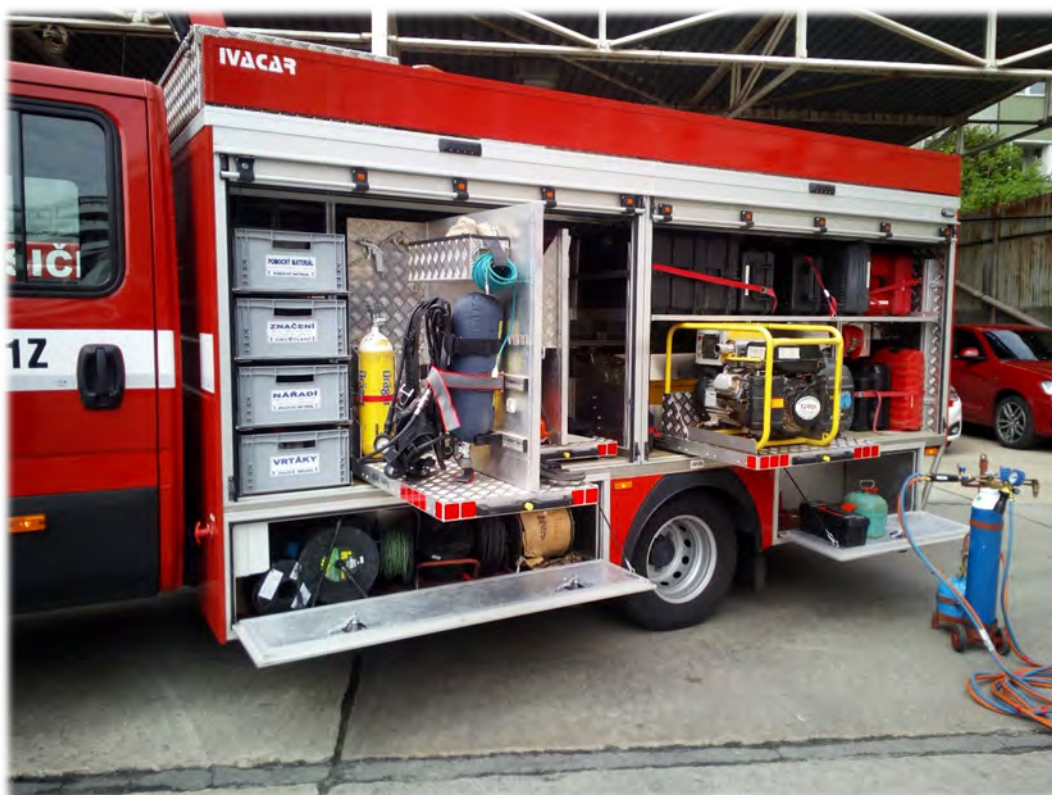
Obrázek 35 - Vozidlo střelmistra, výbava.
