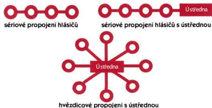
Obr. 4 Síťově provozované systémy
