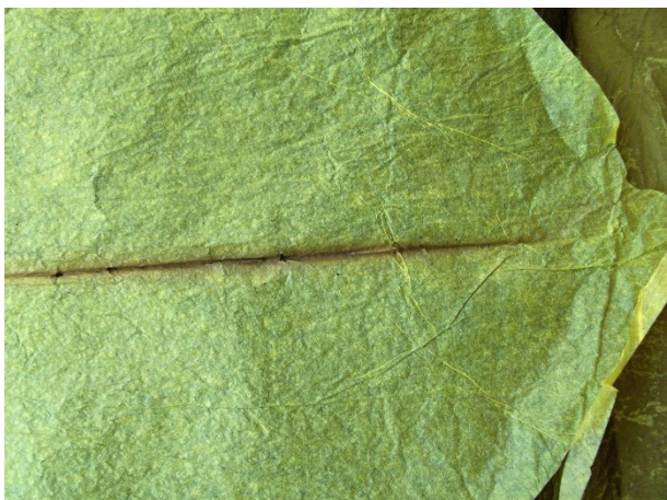
Obr. 21 Degradace pláště v ohybu
