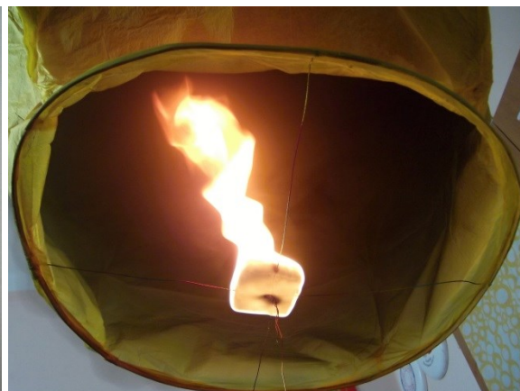
Obr. 16 Bambusová obruč s drátěným křížem a upevněným hořícím palivovým článkem
