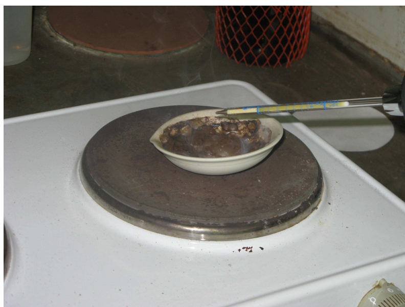
Obr. 3 - Zjišťování výskytu plyných látek pomocí trubiček GASTEC
