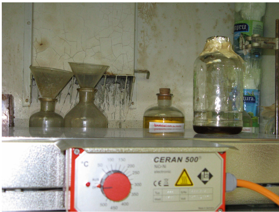
Obr. č. 5 - zahřívání a zachytávání zplodin tepelné degradace (STOMP 400 SC)
