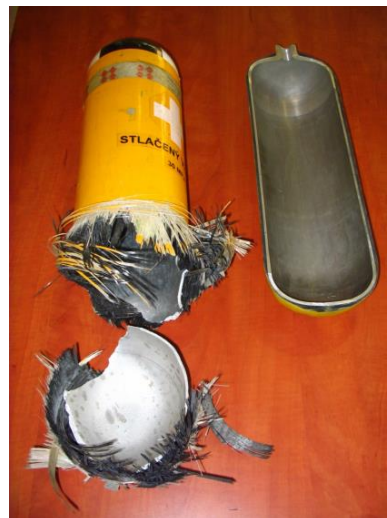
Obr. 4.1 Řez kompozitní tlakovou lahví Obr. 4.2 Destrukce kompozitní tlakové lahve
