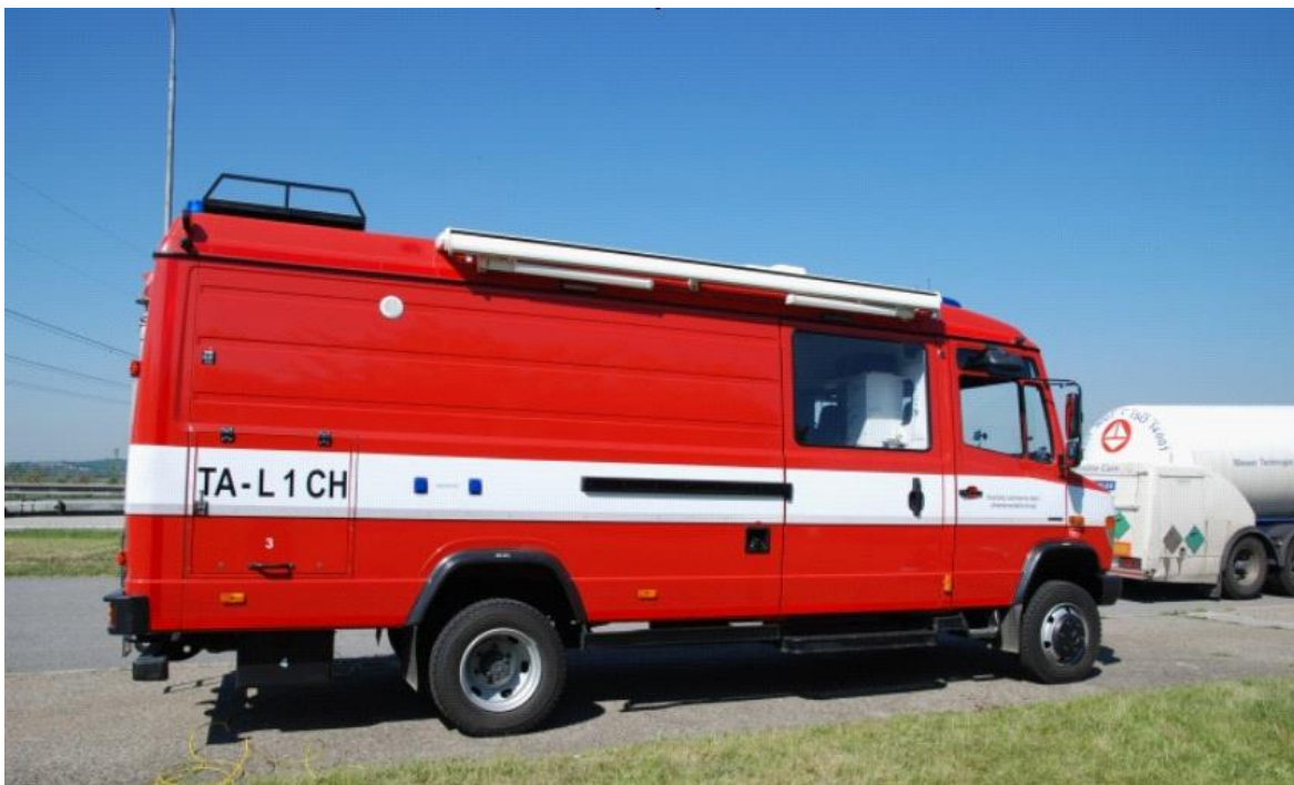
Obr. 7.17 Technický automobil chemický v provedení vozidla chemického a radiačního průzkumu TACHP (Mercedes-Benz Vario)
