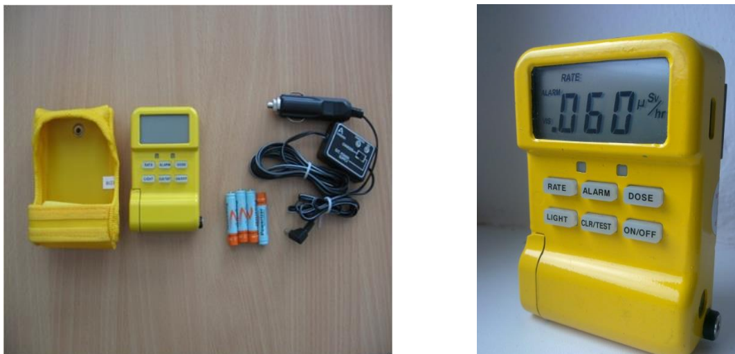
Obr. 9.5 Zásahový dozimetr UltraRadiac u 115 s nabíječkou
