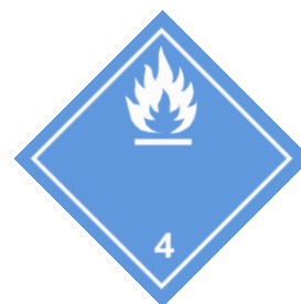
4.3 Látky s vodou vyví- jející hořlavé plyny
