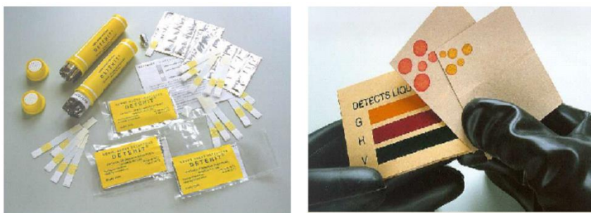
Obr. 7.20 Jednoduché detekční prostředky: Detehit a detekční papírky PP3 (Calid-3)
