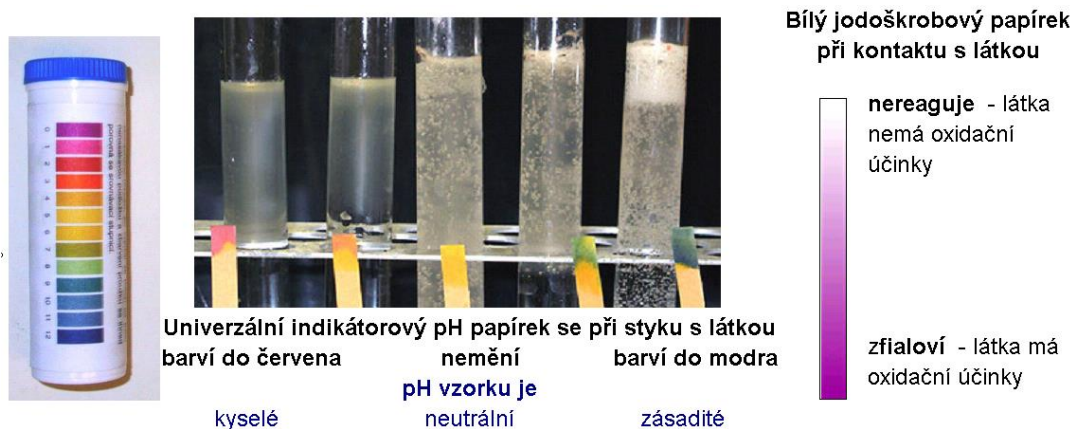
Obr. 7.3 Barevné chemické reakce lakmusového a jodoškrobového papírku vlivem změny pH nebo oxidačních vlastností látky
