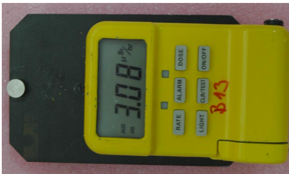
Umístění kontrolního etalonu od DC-3E-98 při kontrole zásahového dozimetru URAD 115 na etalon
