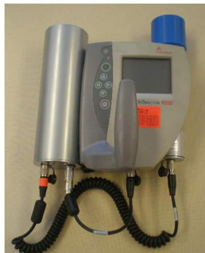
Obr. 9.3 Mobilní spektrometr pro kontinuální monitorování radiální situace iRSS Unispec a přenosný spektrometr InSpector 1000
