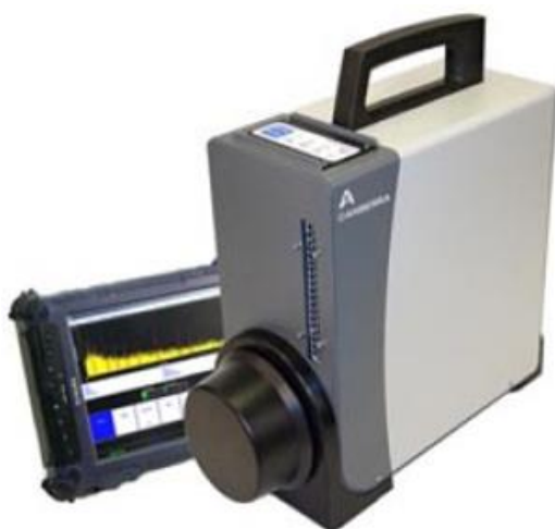
Obr. 9.9 Mobilní polovodičový gama spektrometr Falcon 5000 N a měřič kontaminace alfa, beta, gama Contamat FHT 111H
