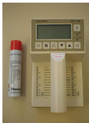
Obr. 9.9 Mobilní polovodičový gama spektrometr Falcon 5000 N a měřič kontaminace alfa, beta, gama Contamat FHT 111H
