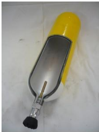
Obr. 4.1 Řez kompozitní tlakovou lahví Obr. 4.2 Destrukce kompozitní tlakové lahve
