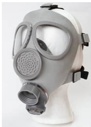
Obr. 3.8 Složení obličejové masky CM4 – lícnice (butylkaučuk, silikonový kaučuk, na vnitřní straně s těsnicí linií); zorník (plexisklo nebo tvrzené sklo); průzvučná (akustická) membrána kovová nebo plastová; vnitřní polomaska (zmenšuje mrtvý prostor v masce, u VDP se směrovými ventily); přípojka; ventilační komora – VDP a FDP nádechový a výdechový ventil – KDP ventily součástí přístroje; upínání – náhlavní kříž, popruh; nosný pás
