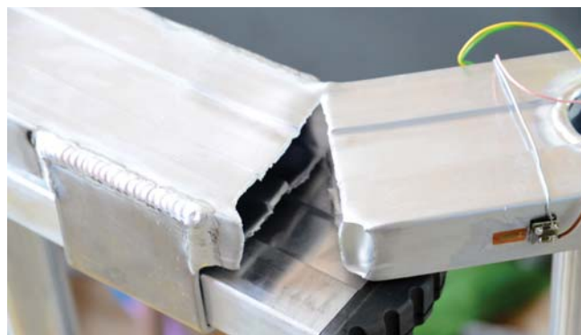
Obr. 8 Celkový pohled na experiment (nahore). Detail rozlomení štěrny při navrženém experimentu (dole).
