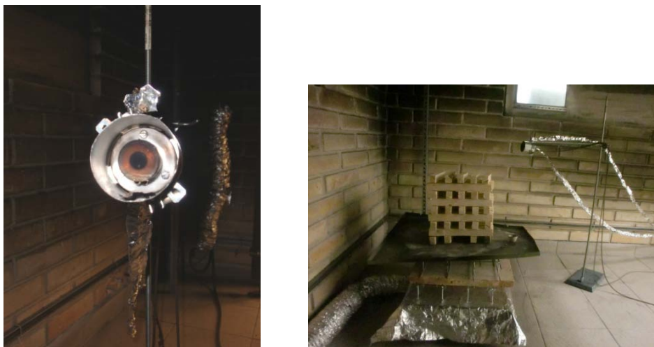
Obr. 4-5: Radiometr a jeho umístění během měření
