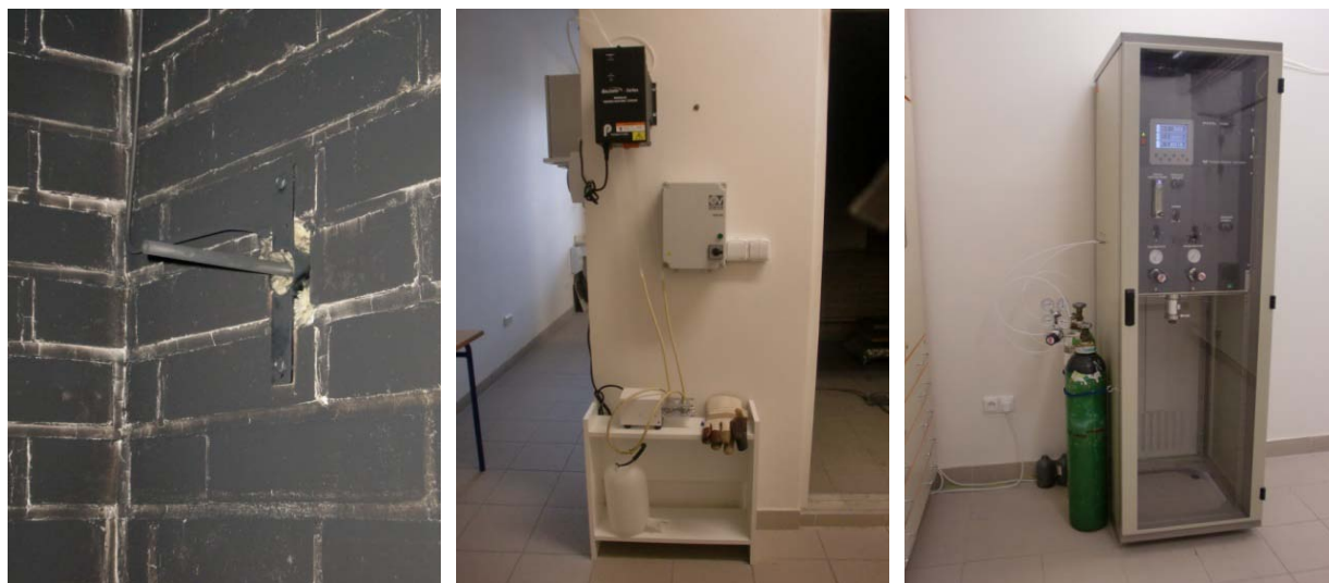
Obr. 4-4: Odběrná trubička, zařízení pro úpravu vzorku a analyzační jednotka
