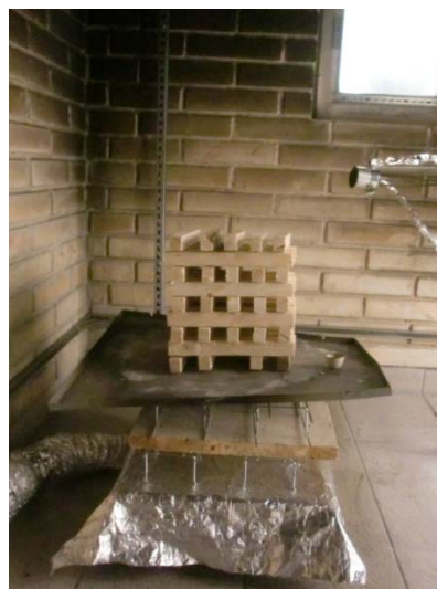
Obr. 4-2: Způsob vyskládání vzorku (rozměry v mm)
