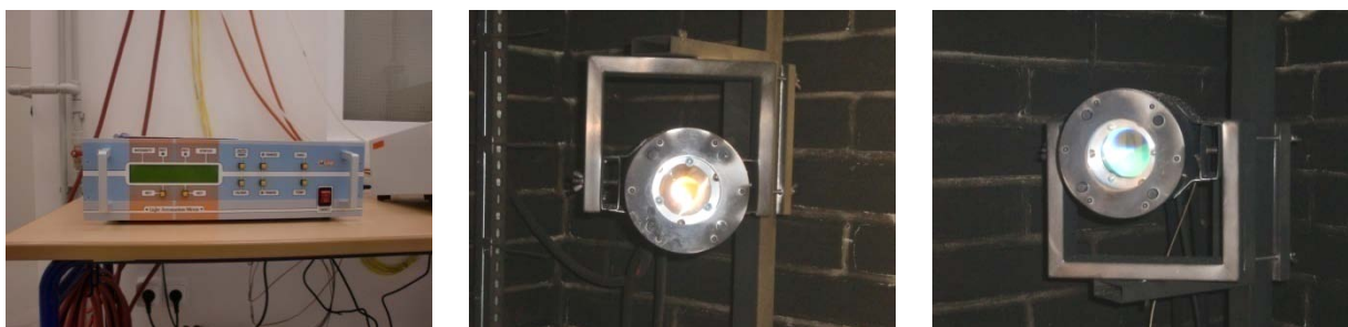
Obr. 4-3: Ústředna, vysílač a detektor přístroje pro měření optické hustoty kouře
