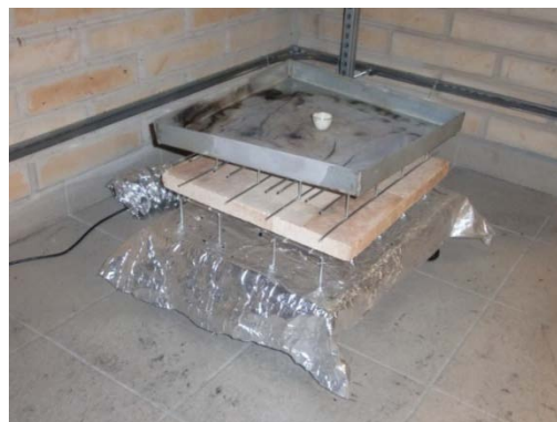
Obr. 4-1: Zkušební materiál a provedení umístění a odclonění váhy
