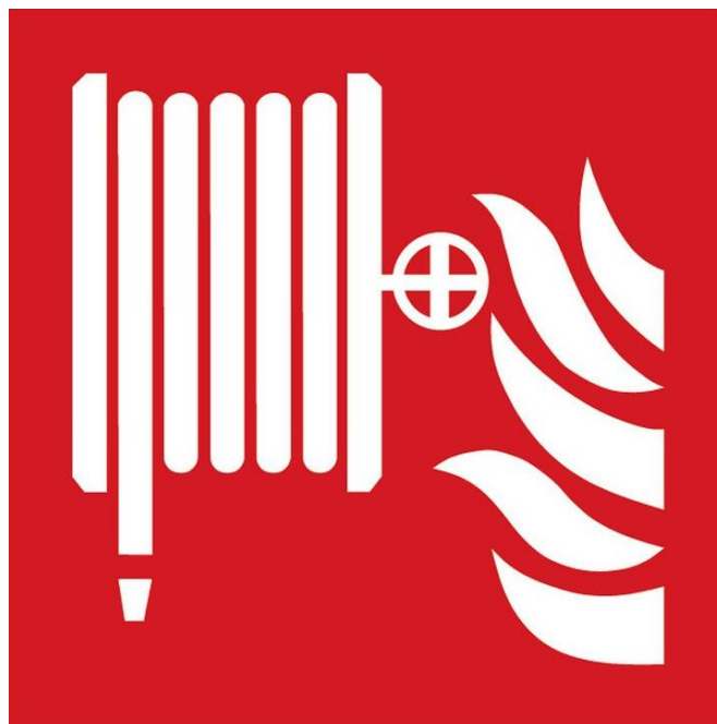
Obrázek 17 – Značka na hydrantu: Požární hadice
