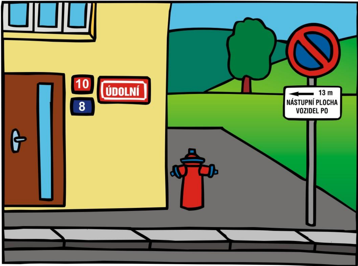
Obrázek 21 – Venkovní hydrant a dopravní značka s dodatkovou tabulkou Nástupní plocha vozidel PO
