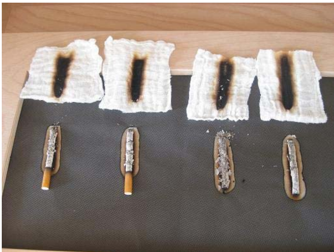
Fotografie 7 Výsledek zkoušky začišťovacího plátna
