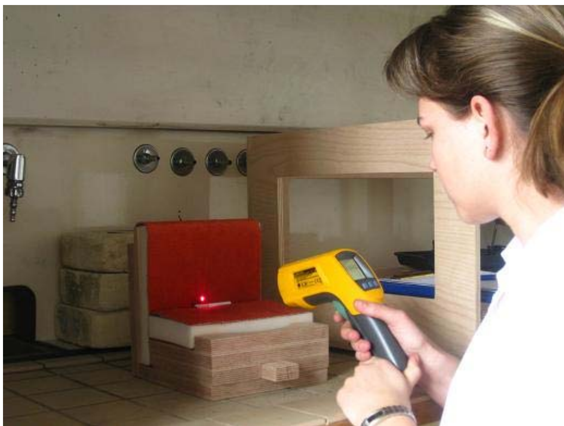
Fotografie 3 Měření teploty při zkoušce materiálu č.3
