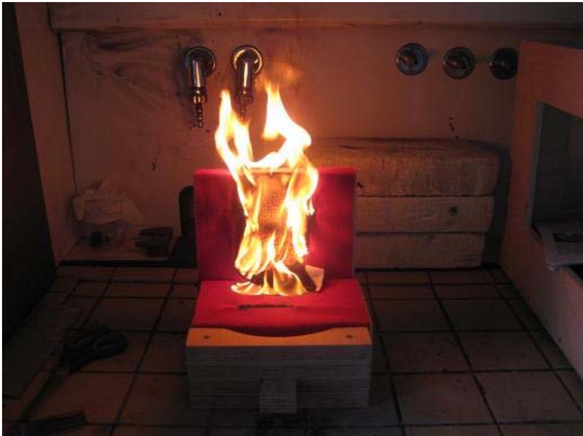
Fotografie 9 Zahoření vzorku zkoušky č. 35
