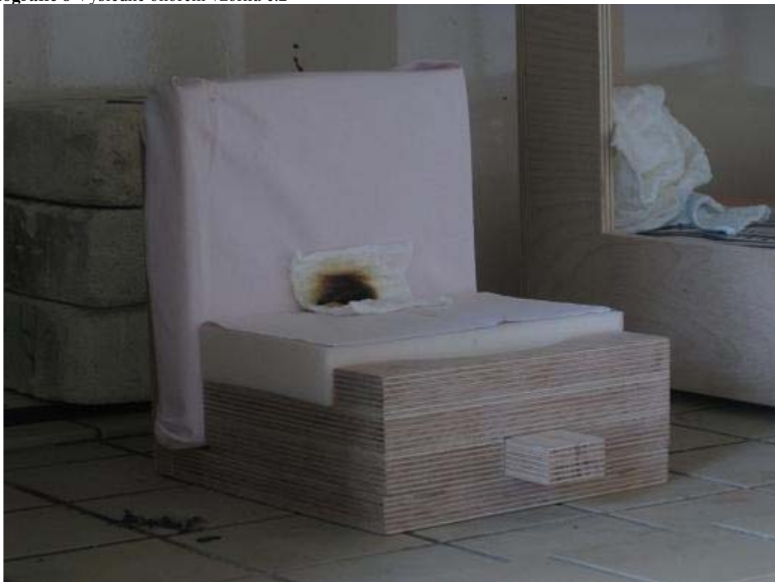
Fotografie 9 Zkušební sestava zkoušek výplní
