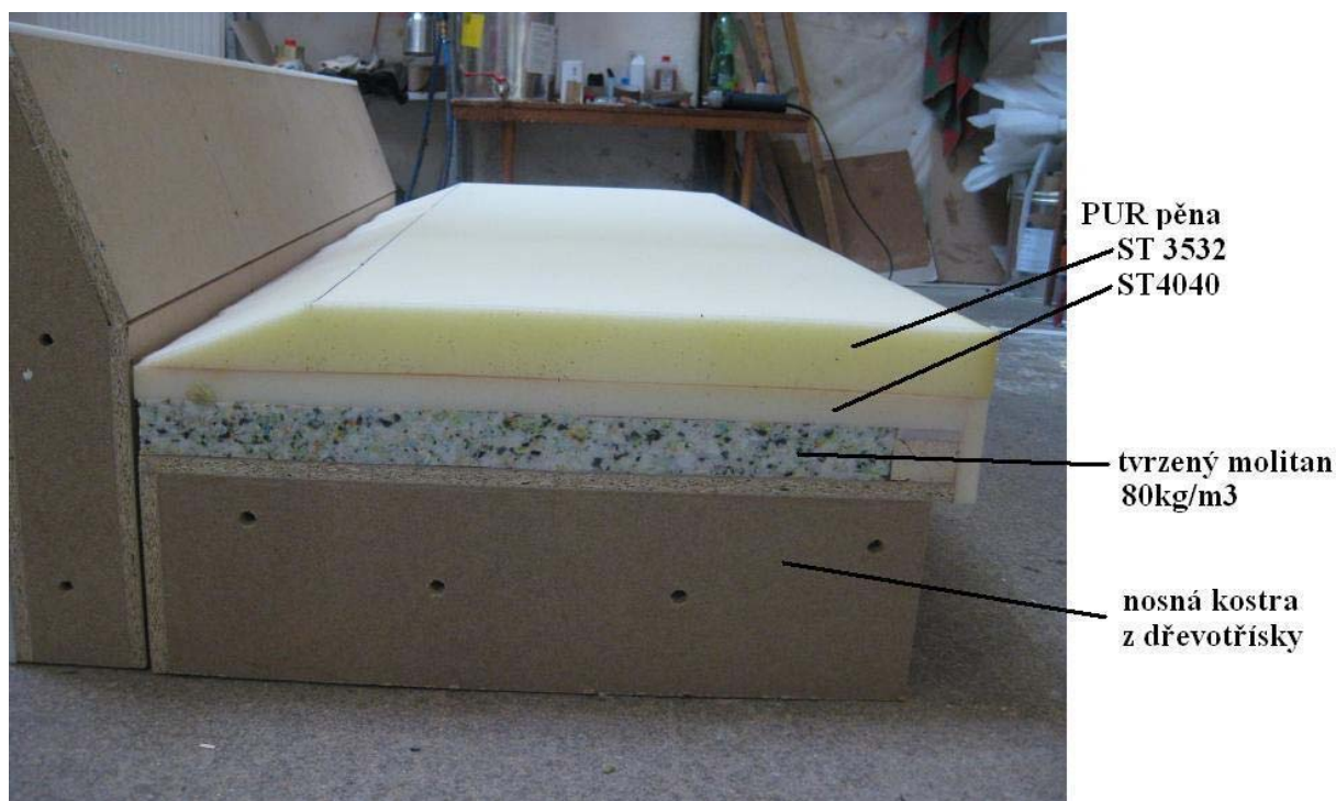
Fotografie 1 Vrstvení PUR pěn u zakázkově vyráběných sedacích souprav
