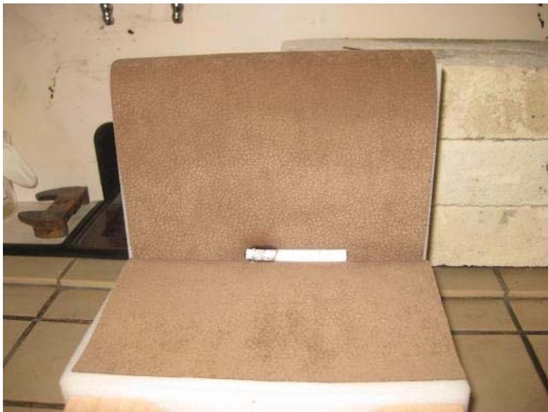
Fotografie 7 Umístění cigarety při zkoušce materiálu č.2
