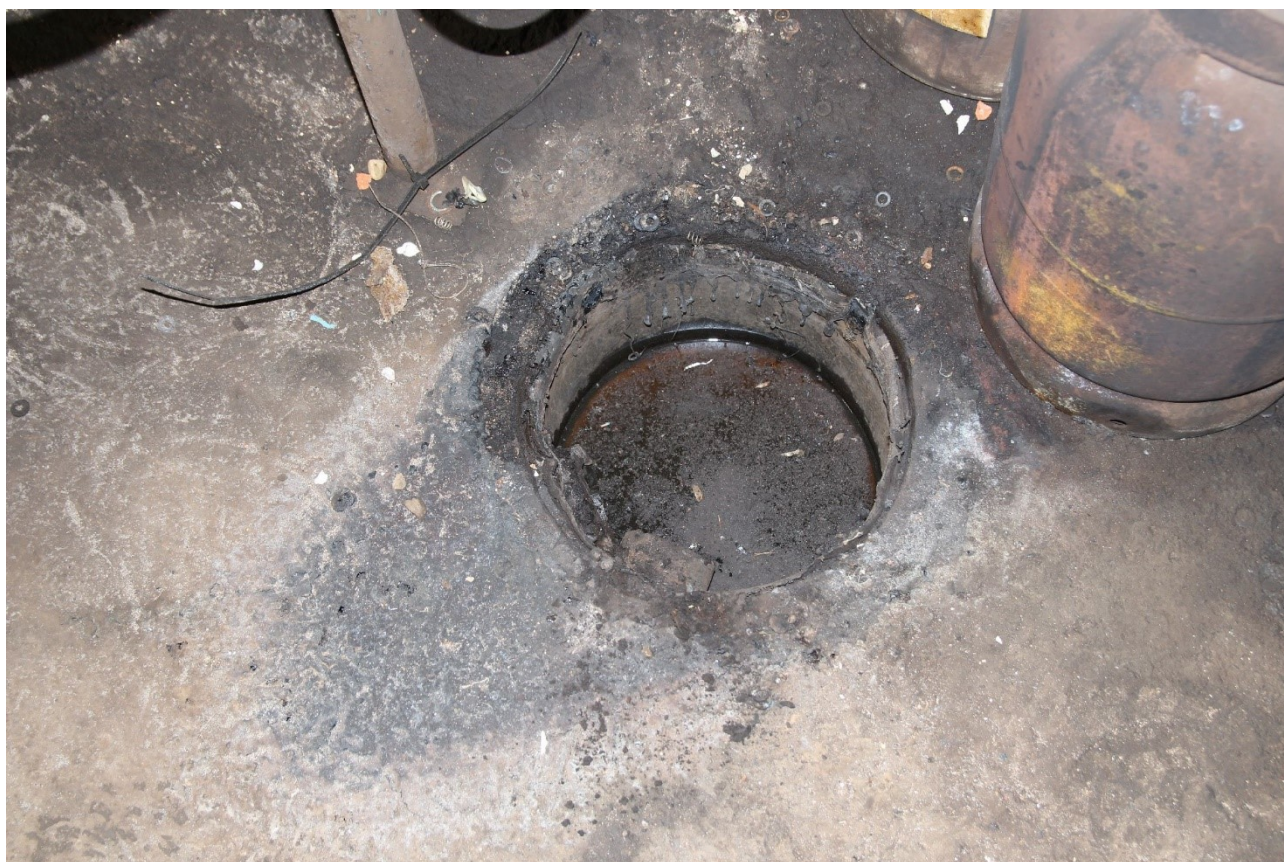
7 Detail vpusti a tlakové lahve bez uzavírací armatury se stopami působení požáru vypovídá o zažehnutí směsi propan-butanu se vzduchem, vyskytující se kolem vpusti a lahve. Propan-butan unikl z lahve a iniciace přišla s implozí u první vpusti
