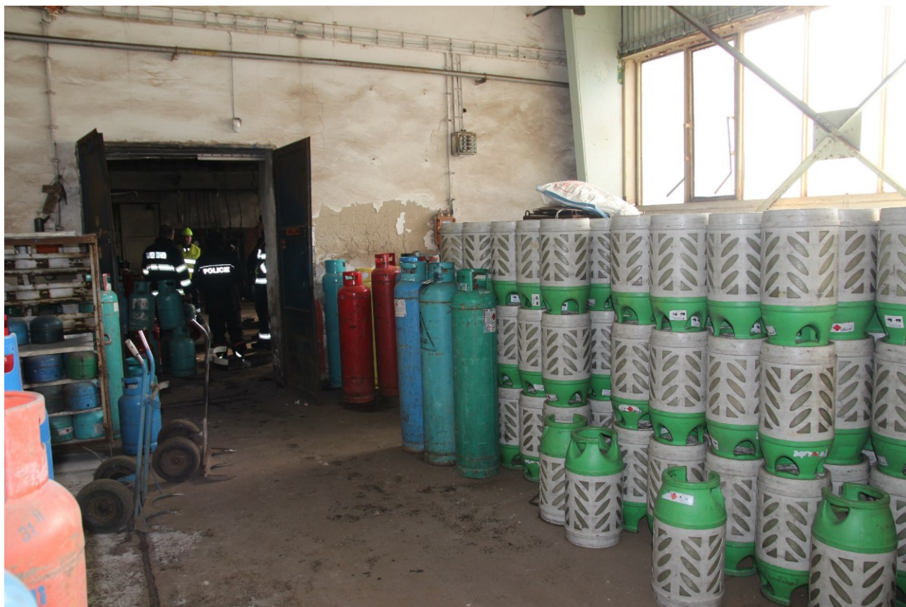
3 Prostor zvaný Příjem – severovýchodní strana. Při ohledání požářiště bylo zjištěno, že dostupné uzavírací armatury 33kg tlakových lahví jsou otevřené
