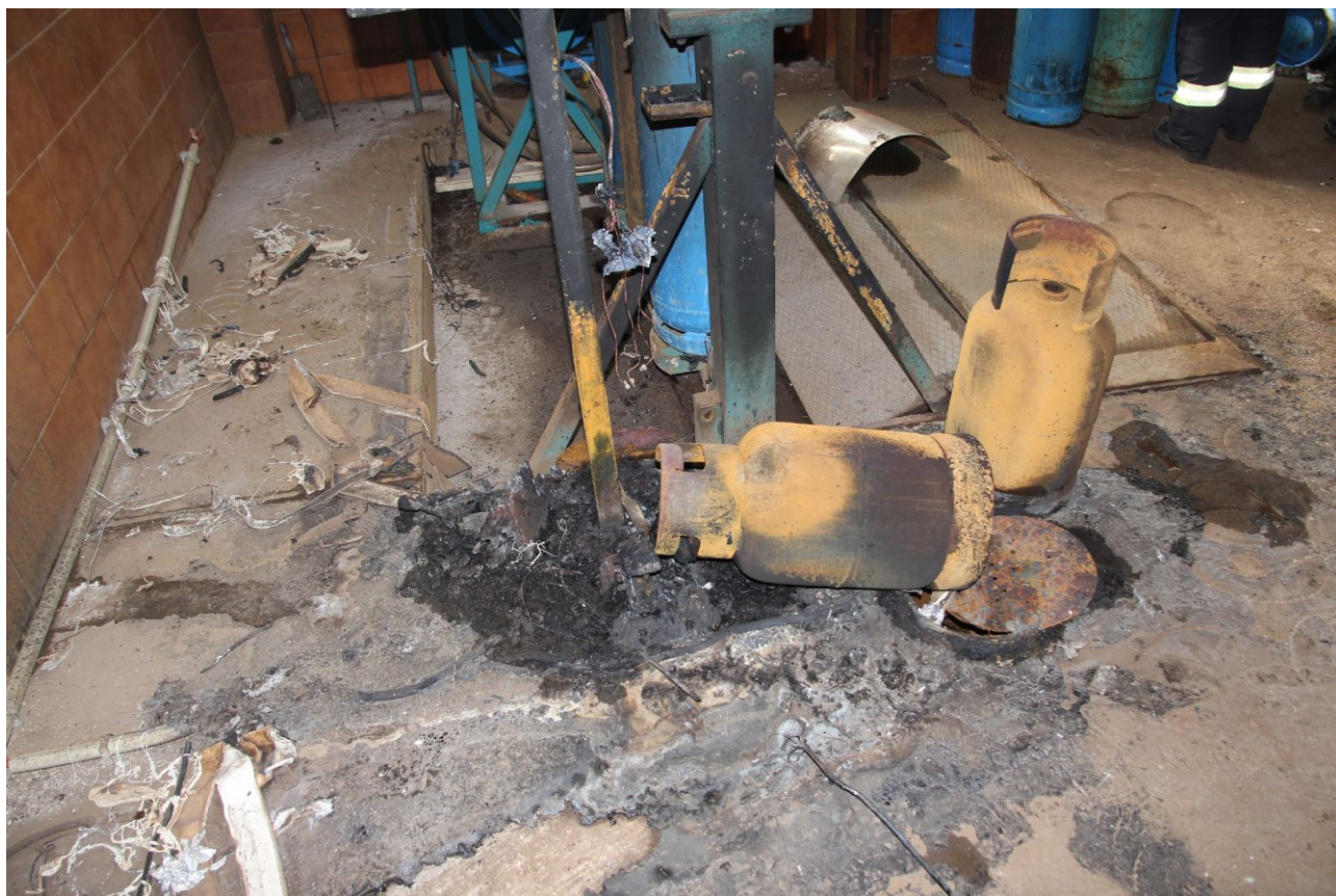
5 Detail místa intenzivního hoření. Tlakové láhve jsou bez uzavíracích armatur a zuhelnatělé stopy na podlaze ukazují, že zde hořela rozlitá, případně tlakem výbuchu po podlaze rozprostřená kapalina
