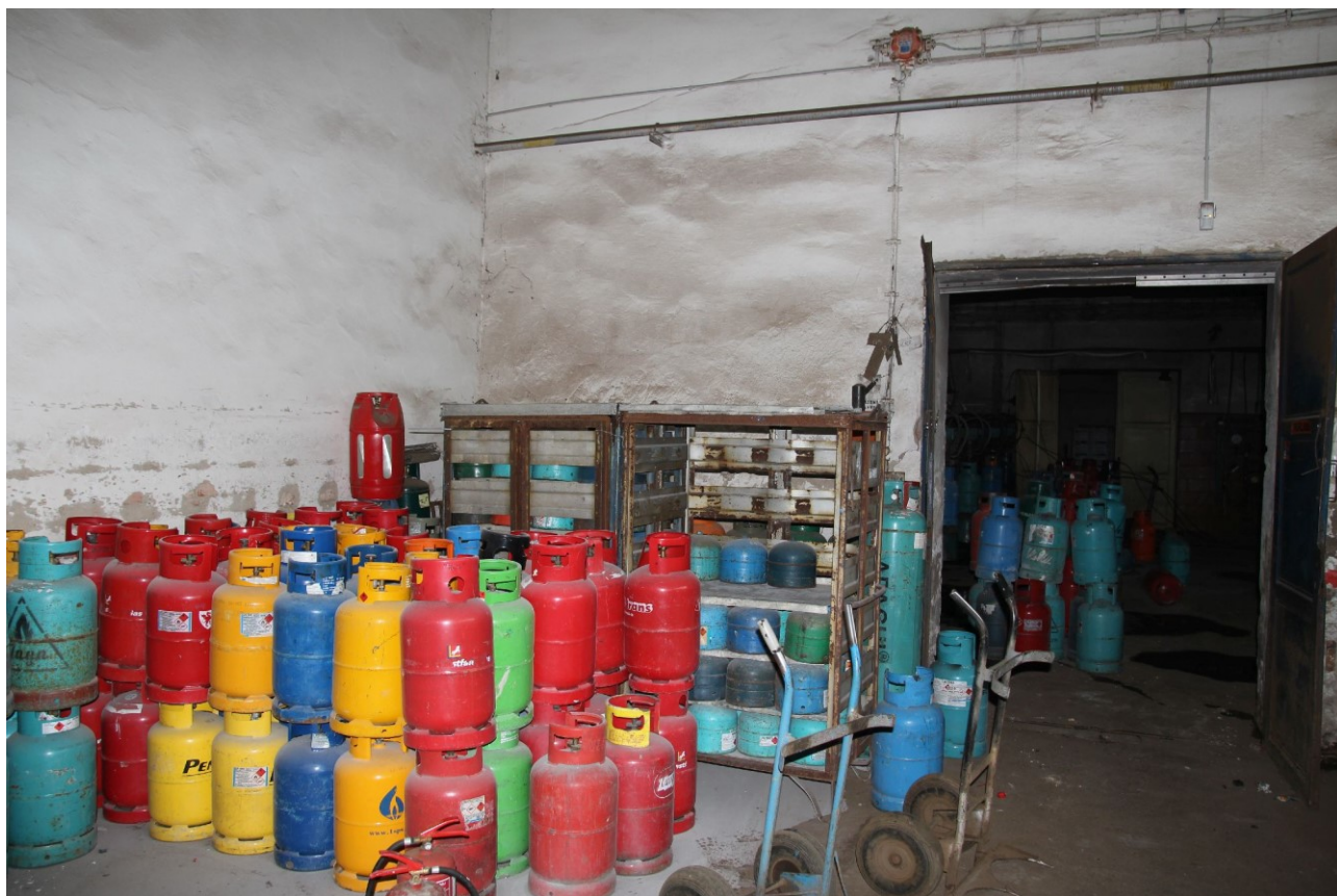
2 Prostor zvaný Příjem – jihovýchodní strana. Při ohledání požářiště bylo zjištěno, že dostupné uzavírací armatury 10kg tlakových lahví jsou otevřené
