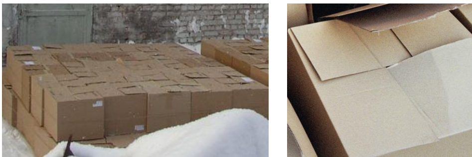
Obr. č.14: Skládání krabic a stahování jednotlivých pater
