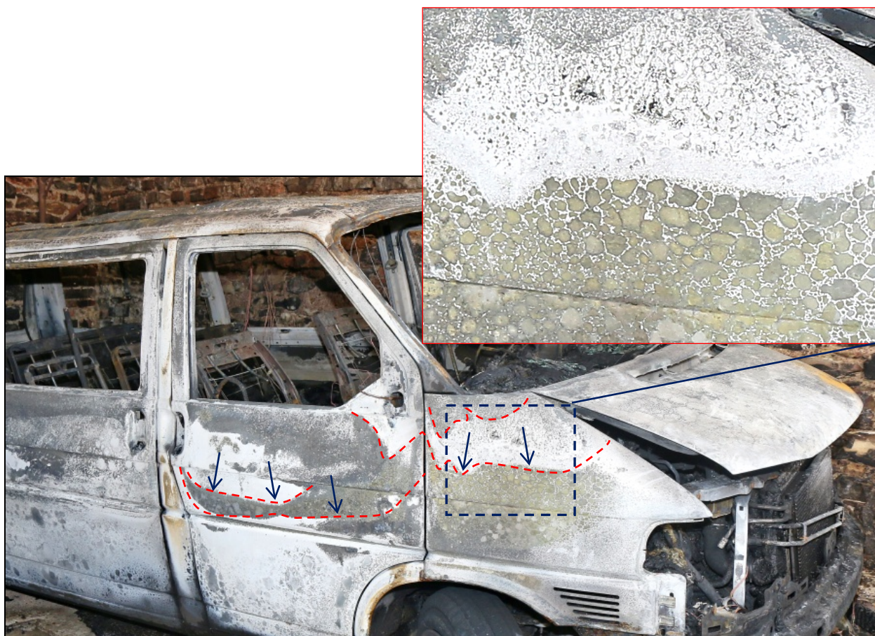
Obr. č. 12: Pohled na stopy způsobené převažujícím vnějším tepelným namáháním, jehož intenzita stoupala a tepelně degradovaná plocha se rozšiřovala ve směru šipek. V modrém ohraničení detailní pohled na strukturu.
