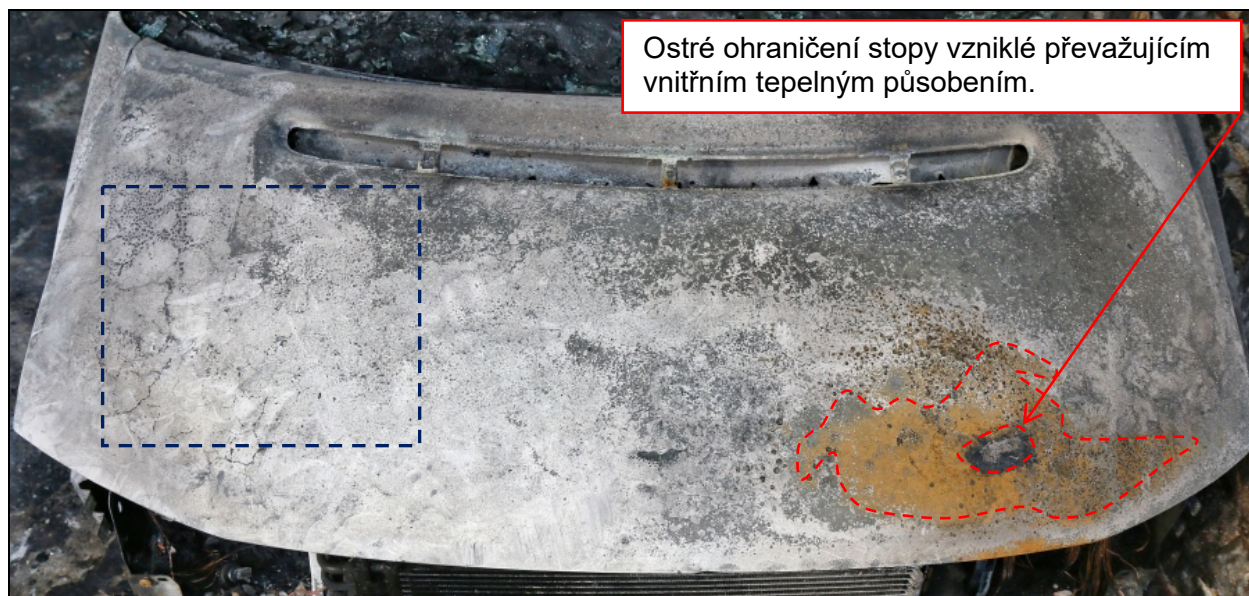
Obr. č. 13: Pohled na stopy znatelné na přední kapotě vozidla způsobené převažujícím vnějším tepelným namáháním (modré ohraničení). Červené ohraničení zobrazuje uzavřené stopy způsobené v důsledku převažujícího vnitřního tepelného působení. Tyto stopy jsou způsobeny hořením uniklé náplně klimatizace.
