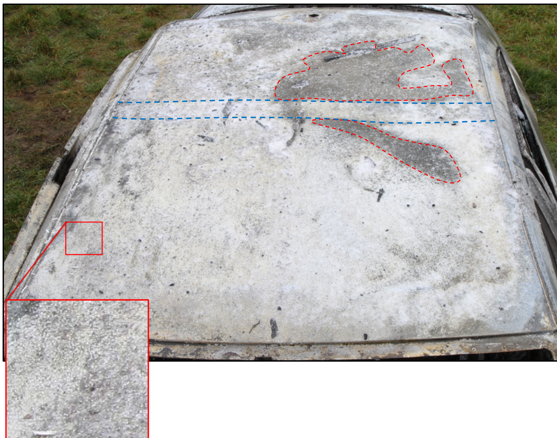
Obr. č. 11: Pohled na stopy znatelné na střeše vozidla způsobené převažujícím vnějším tepelným namáháním. V zadní části střechy jsou modře zvýrazněny stopy způsobené již převažujícím vnitřním tepelným namáháním (červeně ohraničené).
