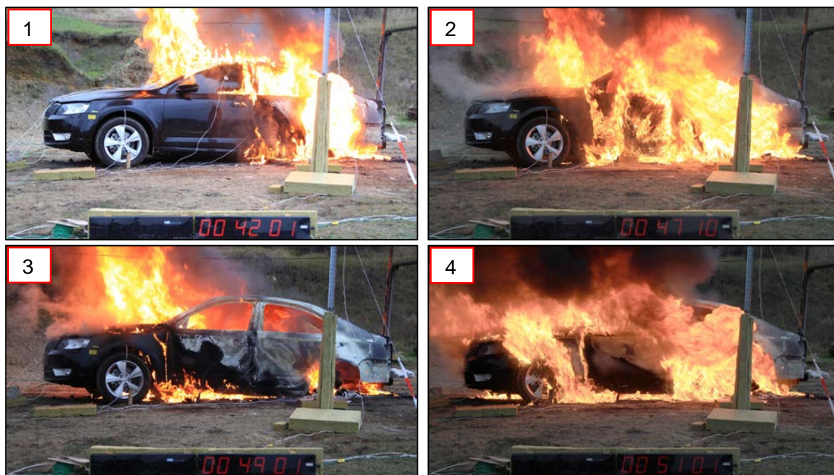
Skupina obr. č. 9: Pohled na podélné tepelné namáhání povrchu přední kapoty vozidla v době, kdy docházelo k tepelné degradaci laku karoserie.
