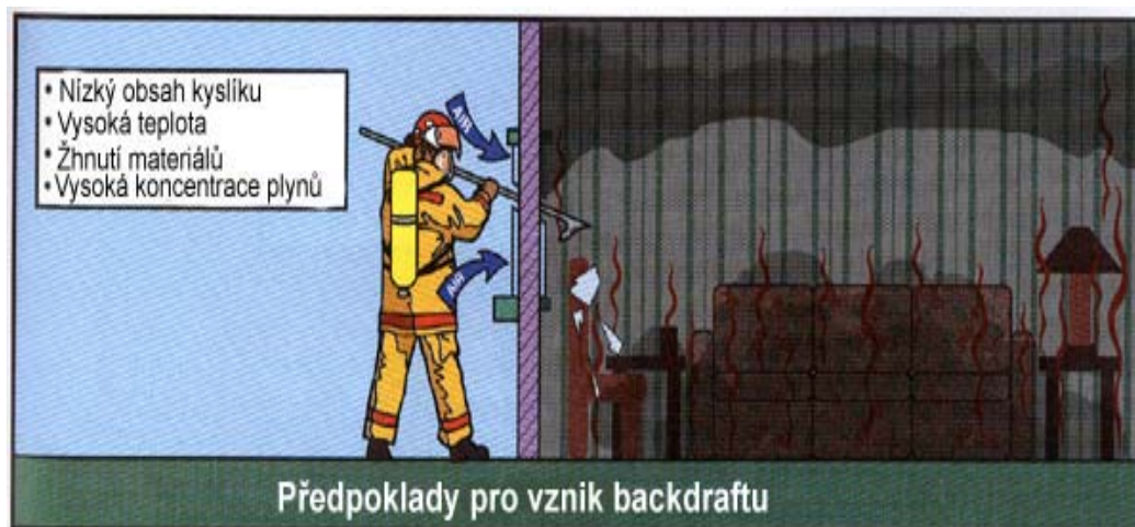
Obr. 3.2 Narušení těsnosti místnosti
