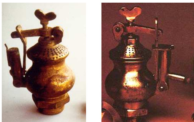
Obr. 4.9 – Sprinklerová hlavice se zápalnou šňůrou [25]
