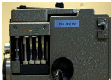
Obr. 4: Odběr vzorků vzduchu na sorpční trubičku pomocí chemického průkazníku CHP-71
