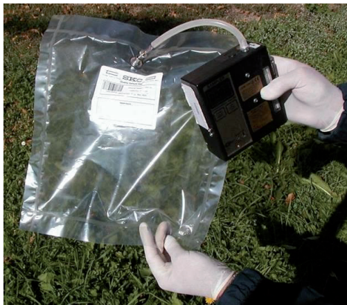
Obr. 1: Odběr vzorků vzduchu do vzorkovacího vaku pomocí plynového odběrového čerpadla
