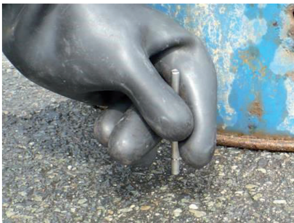
Obr. 2: Pasivní vzorkování par nad hladinou kapaliny
