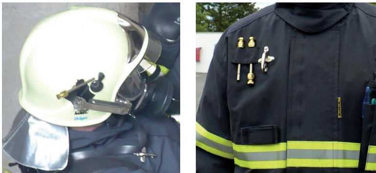
Obr. 3: Možnosti uchycení sorpčních trubiček při monitorování personální expozice.
