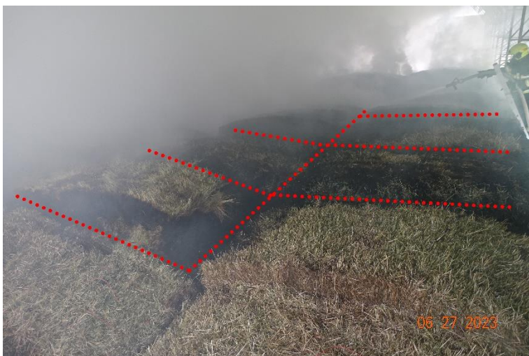
Obr. 5 Prohoření lisovaných balíků na styčných plochách dokládající šíření z vnitřních struktur (vyznačeno červeně)
