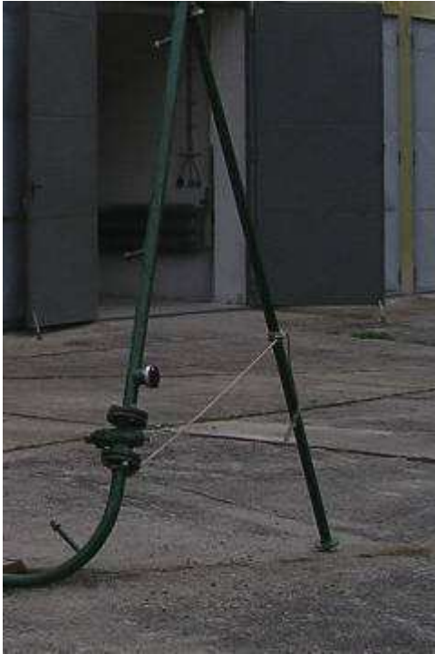
Obr. 51 Detail zajištění lanem
