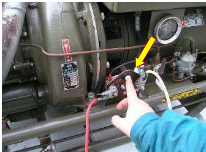
Obr. 66 Stlačení tlačítka start pro startování pomocí akumulátoru
