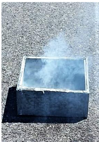
Obr. 4a Zahoření tuhé hmoty fosforového odpadu
