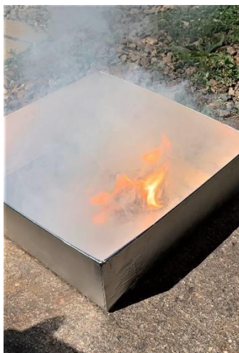
Obr. 4b Zahoření tuhé hmoty fosforového odpadu na PE fólii
