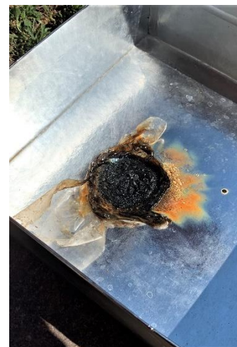
Obr. 4c Seškvařená a zuhelnatělá PE fólie po hoření fosforu na jejím povrchu
