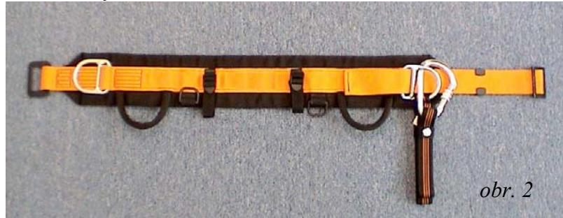
5) Polohovací pás je osobním ochranným prostředkem každého hasiče. Nedílnou součástí polohovacího pásu je karabina se zámkem, pojistkou zámku a s pevností minimálně 22 kN v podélném směru. Doporučuje se karabina ocelová typu HMS.
