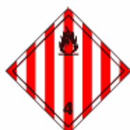
nebezpečí požáru hořlavé tuhé látky
