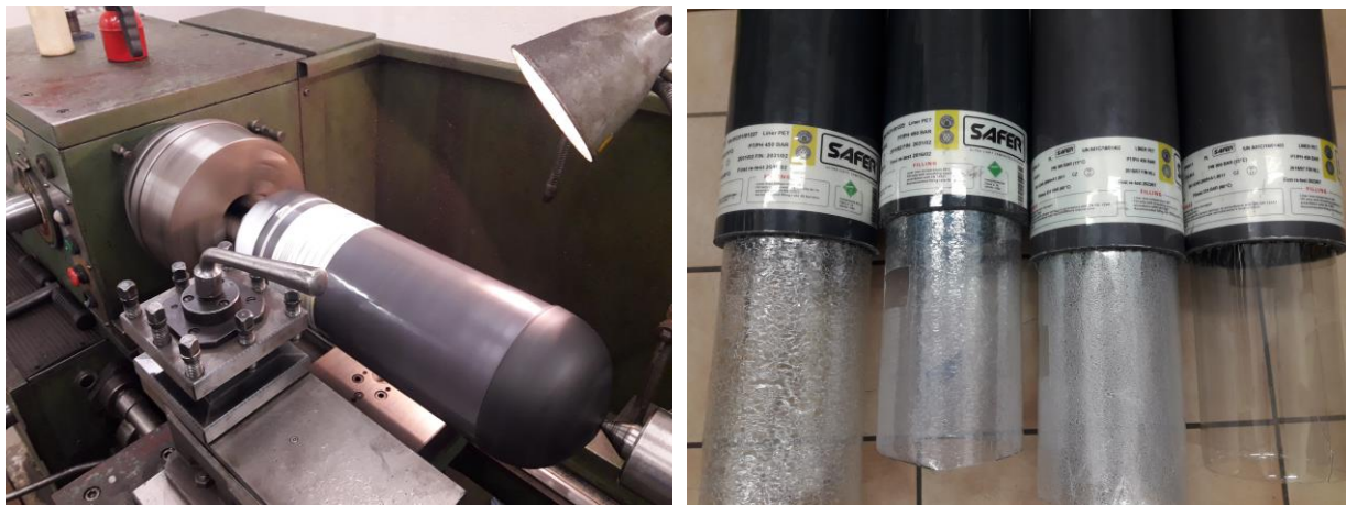
Obr. 18 a, b Řez lahví, jednotlivé lahve po vytažení lineru a odběru vzorků
