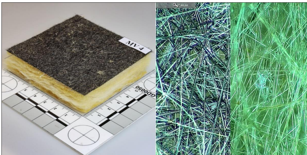
Obrázek 13 - Pohled na vzorek MV4 (vpravo snímek z digitálního mikroskopu - 68 x zvětšeno)
