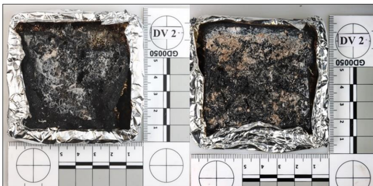
Obrázek 30 - Pohled na vzorky DV2 po měřeních (zleva: 25 kW/m 2 se zk. plamenem, 50 kW/m 2 bez zk. plamene)
