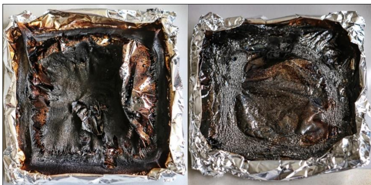
Obrázek 33 - Pohled na vzorky PUR-S po měřeních (zleva: 25 kW/m 2 se zk. plamenem, 50 kW/m 2 bez zk. plamene)
