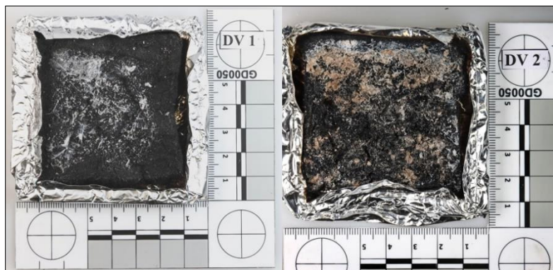
Obrázek 29 - Pohled na vzorky DV1 po měřeních (zleva: 25 kW/m 2 se zk. plamenem, 50 kW/m 2 bez zk. plamene)
