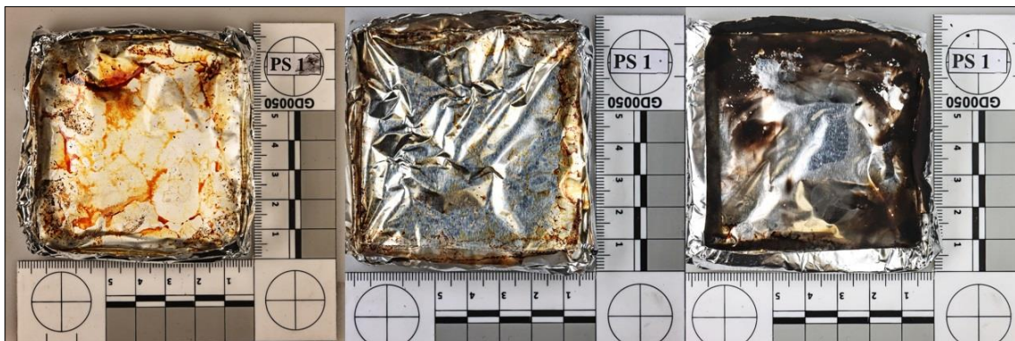
Obrázek 20 - Pohled na vzorky PS1 po měřeních (zleva: 25 kW/m 2 se zk. plamenem, 50 kW/m 2 bez zk. plamene – nehořel, 50 kW/m 2 bez zk. plamene – hořel)
