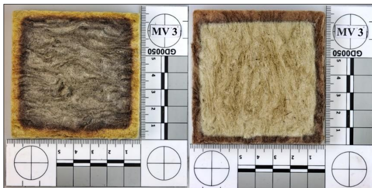
Obrázek 27 - Pohled na vzorky MV3 po měřeních (zleva: 25 kW/m 2 se zk. plamenem, 50 kW/m 2 bez zk. plamene)
