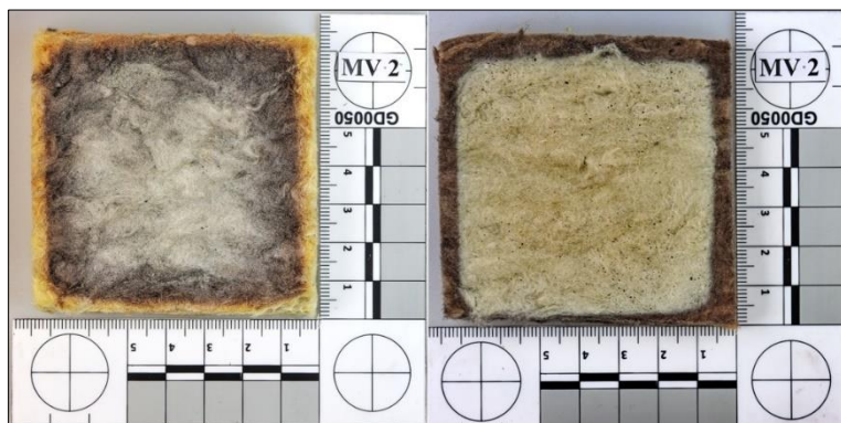
Obrázek 26 - Pohled na vzorky MV2 po měřeních (zleva: 25 kW/m 2 se zk. plamenem, 50 kW/m 2 bez zk. plamene)
