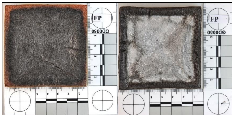
Obrázek 34 - Pohled na vzorky FP po měřeních (zleva: 25 kW/m 2 se zk. plamenem, 50 kW/m 2 bez zk. plamene)
