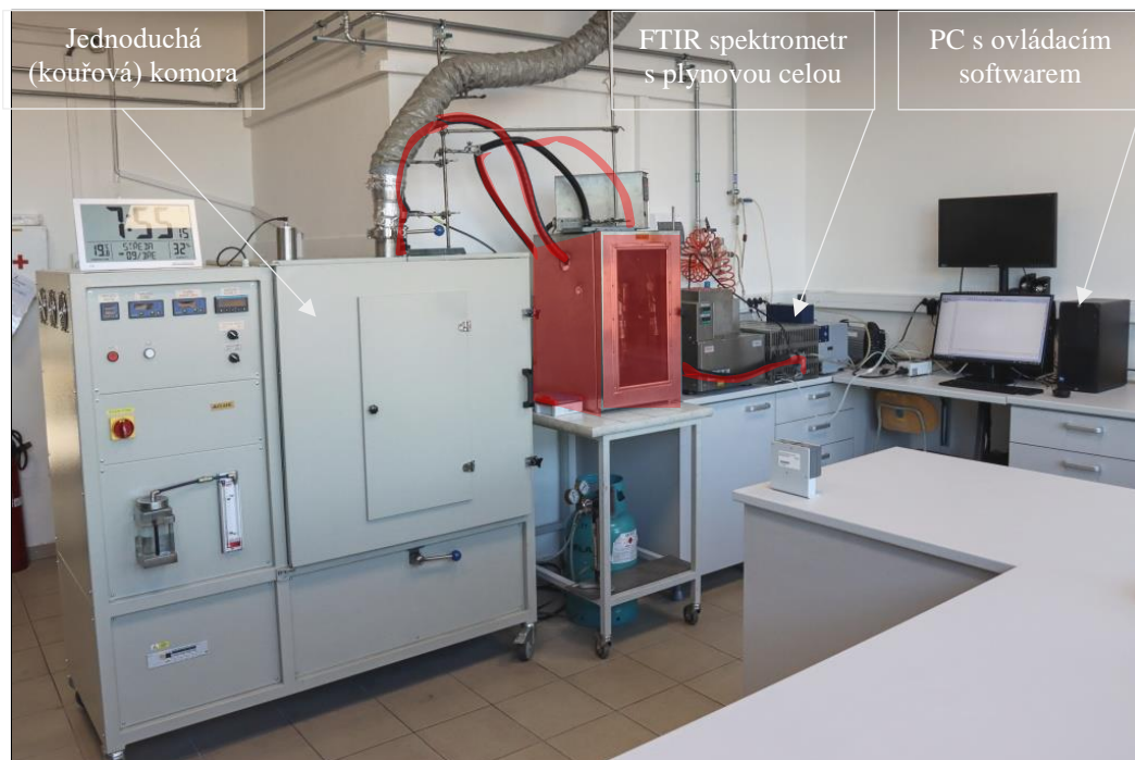
Obrázek 3 - Pohled na měřicí sestavu v laboratoři včetně popisu (červeně vyznačena vyhřívání cesta plynů)
