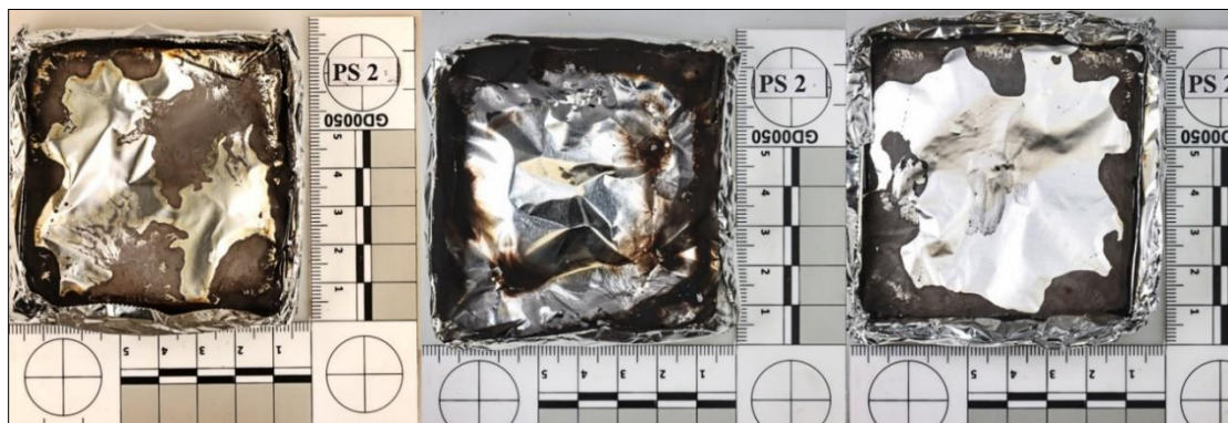
Obrázek 21 - Pohled na vzorky PS2 po měřeních (zleva: 25 kW/m 2 se zk. plamenem, 50 kW/m 2 bez zk. plamene – nehořel, 50 kW/m 2 bez zk. plamene – hořel)
