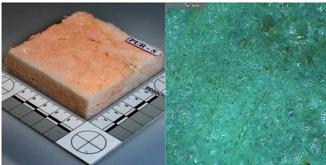
Obrázek 18 - Pohled na vzorek PUR-S (vpravo snímek z digitálního mikroskopu - 68x zvětšeno)
