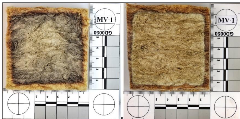
Obrázek 25 - Pohled na vzorky MV1 po měřeních (zleva: 25 kW/m 2 se zk. plamenem, 50 kW/m 2 bez zk. plamene)
