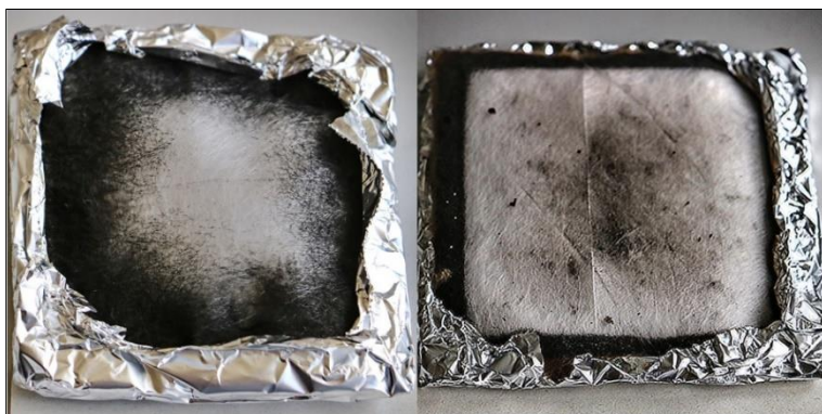
Obrázek 28 - Pohled na vzorky MV4 po měřeních (zleva: 25 kW/m 2 se zk. plamenem, 50 kW/m 2 bez zk. plamene)
