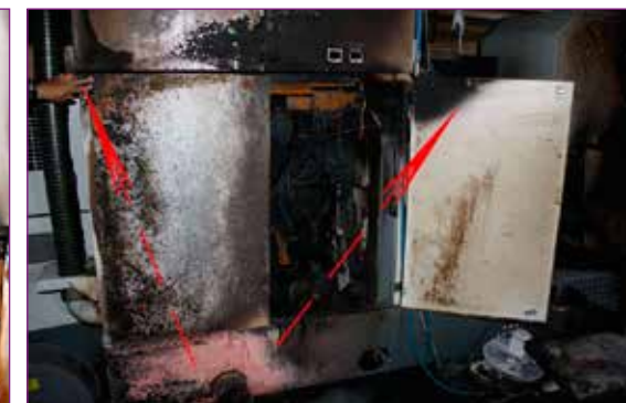
Obr. č. 4 – Převodovková skříň – ohniskové markanty.
