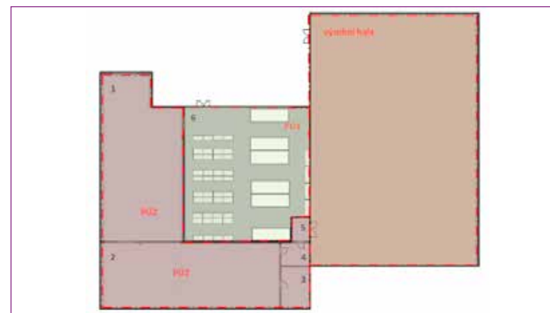
Obr. č. 1 – Rozdělení objektu do požárních úseků.
