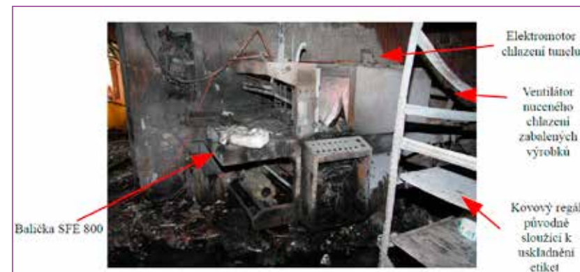
Obr. č. 6 – Balička SFE 800 po požáru.
