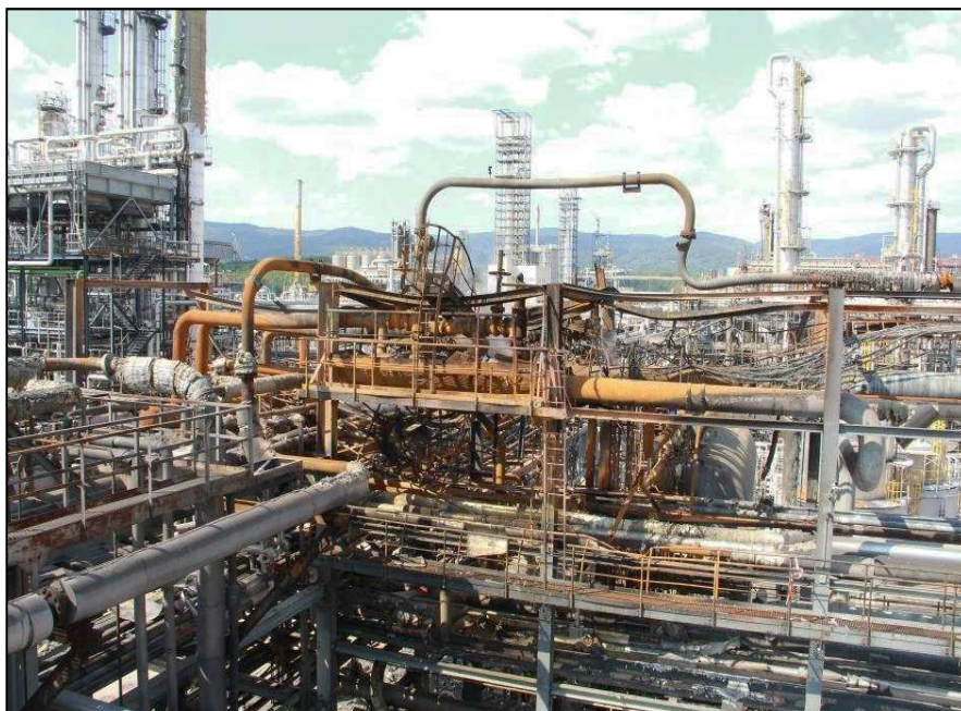
Obrázek č. 11: Unipetrol, Záluží u Mostu - ethylenová jednotka poškozená výbuchem s následným požárem
