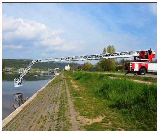
Obrázek č. 6: Zkouška pracovního pole automobilového žebříku
