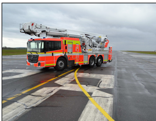
Obrázek č. 7: Zkoušky jízdních vlastností automobilové plošiny
