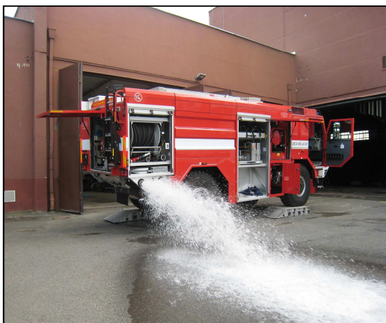
Obrázek č. 9: Zkouška mezinápravové průchodnosti cisternové automobilové stříkačky
