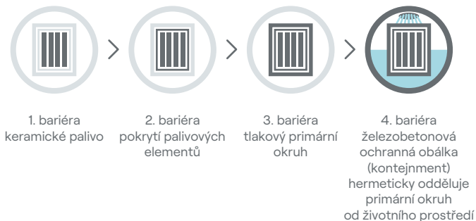
Principiální schéma ochranných bariér jaderné elektrárny
