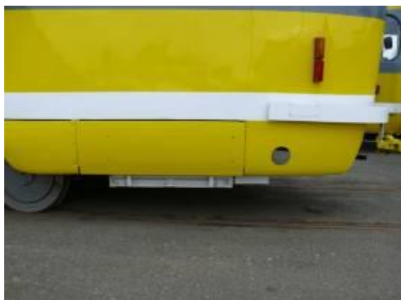
Obr. č. 13 Uložení baterií
