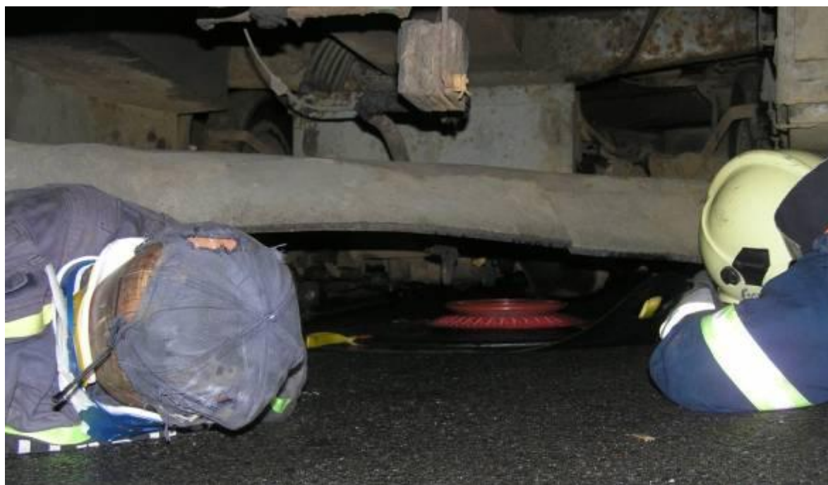
Obr. č. 53 Umístění vaků pod převodovou skříň
