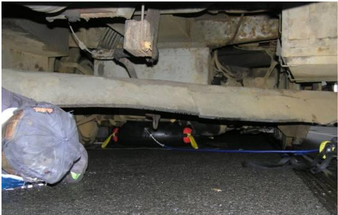
Obr. č. 54 Zvednutí tramvaje za pomoci vaků
